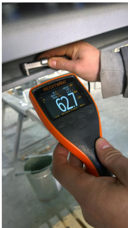
Slika 6.10 Mjerenje debljine suhog filma
