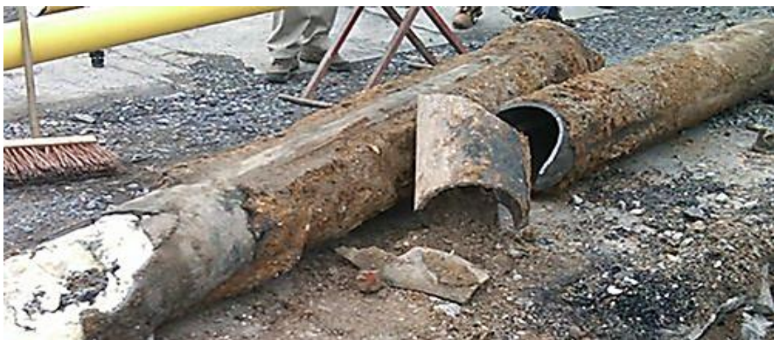
Slika 4.18 Tamne mrlje na vanjskoj strani cijevi predstavljaju oblik korozije specifične za lijevano željezo poznato kao grafitizacija sivog lijeva [32]
