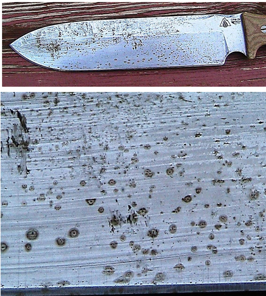
Slika 4.12 Primjer pjegaste korozije na oštrici noža [23]
