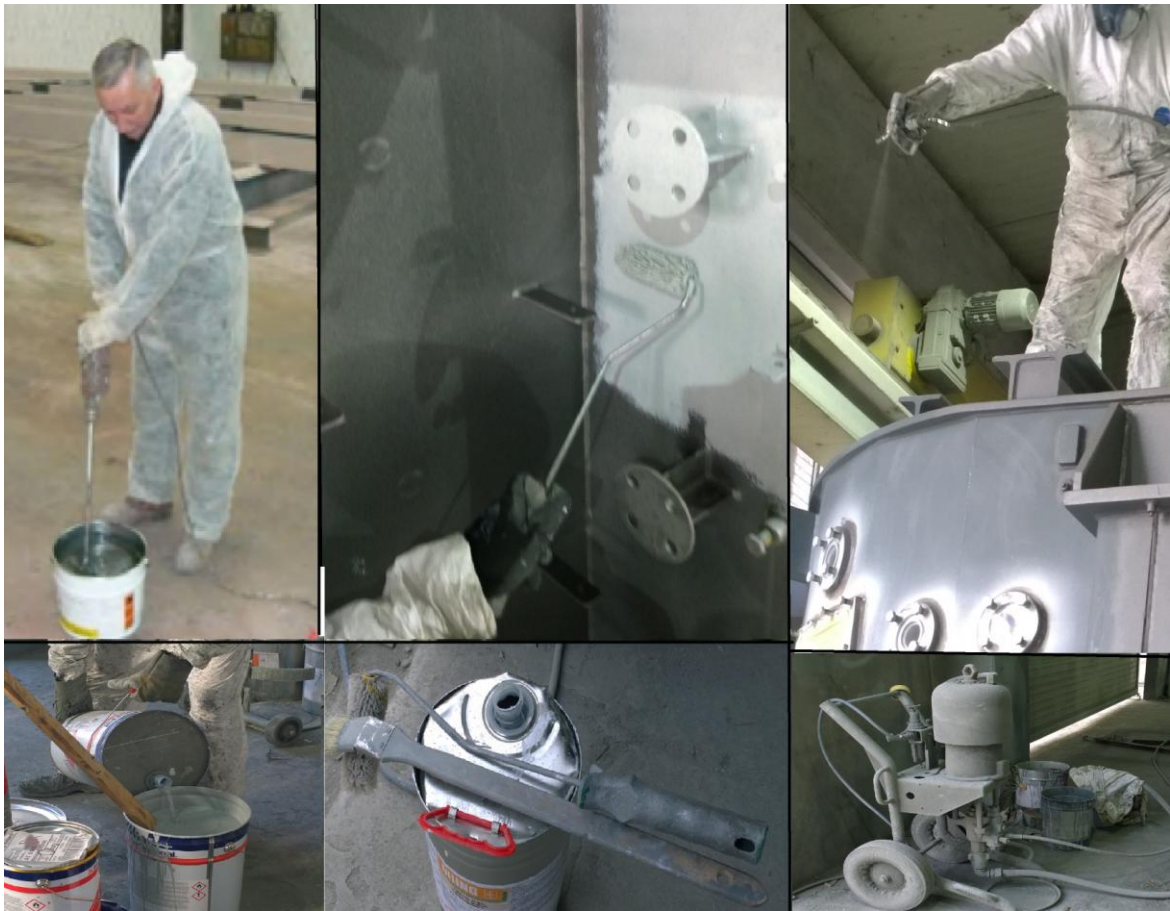
Slika 6.9 Mješanje boje, flekanje, špricanje
