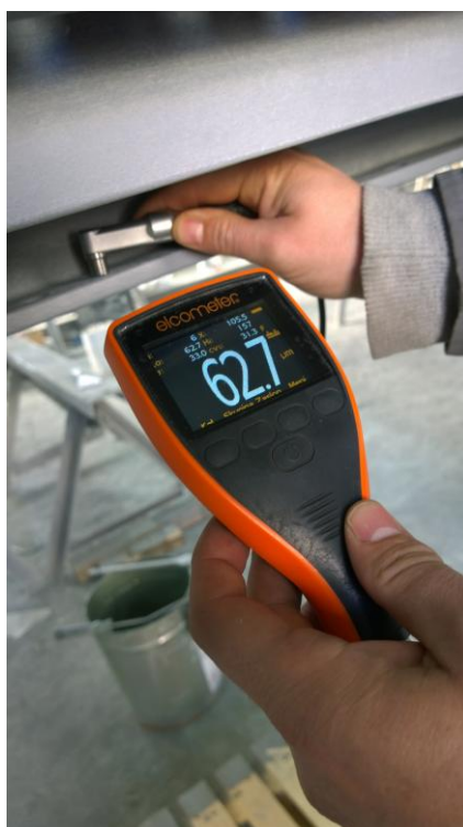
Slika 6.10 Mjerenje debljine suhog filma
