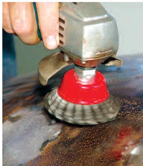
Slika lijevo prikazuje brušenje brusnim papirom, a slika desno žičanom četkom
