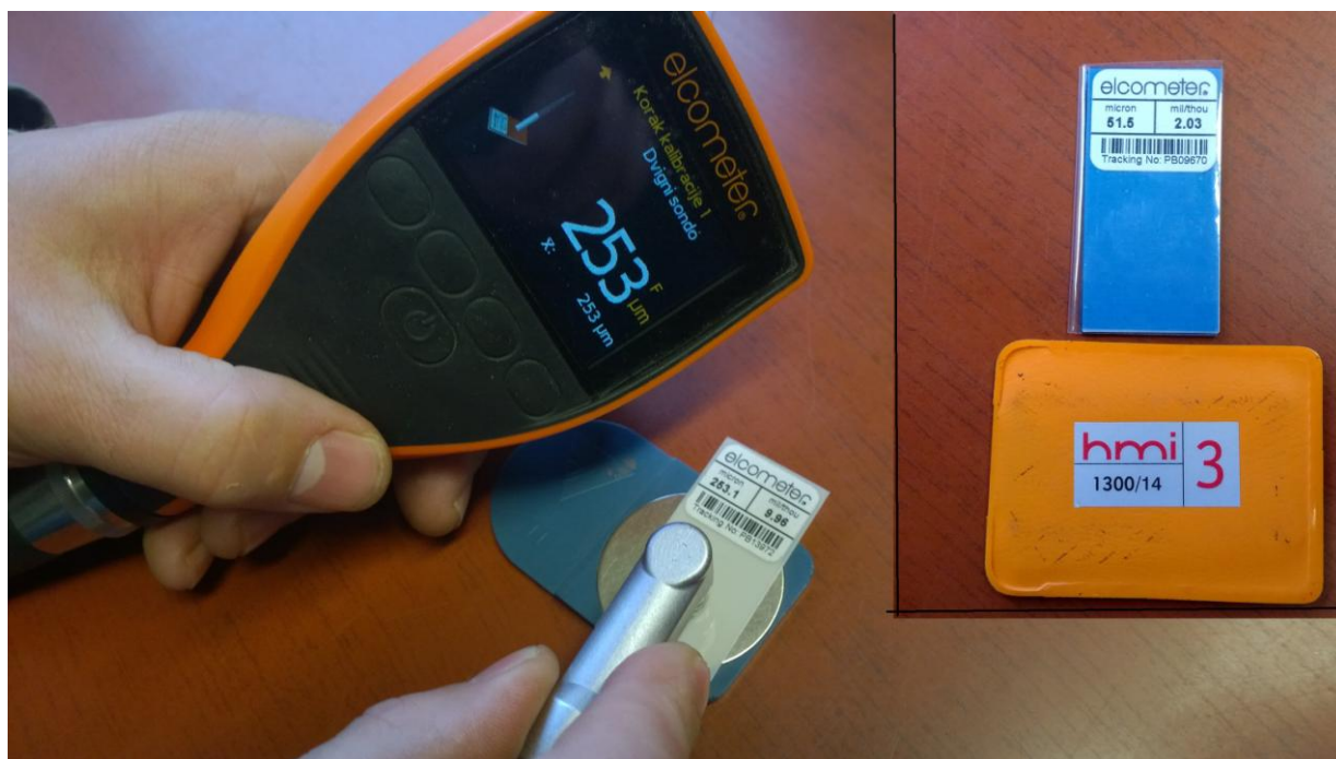
Slika 6.21 Kalibriranje prije završnog ispitivanja
