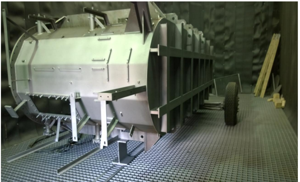
Slika 6.3 Kotao u postupku sačmarenja
