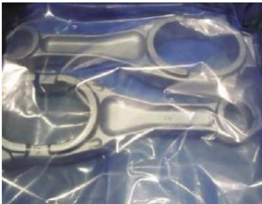
Slika 5.27 Zaštita dijelova motora u omotu sa hlapivim inhibitorima [48]
