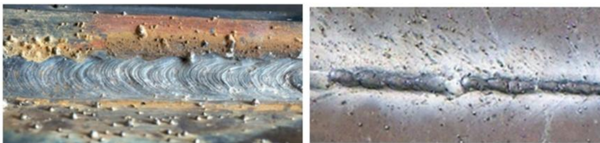
Slika 8.2 Izgled prskanja ili štrcanja kod zavarivanja [3]
