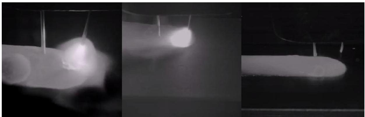
Slika 10.3 Realni prikaz prijenosa metala kod tandem zavarivanja [29]
