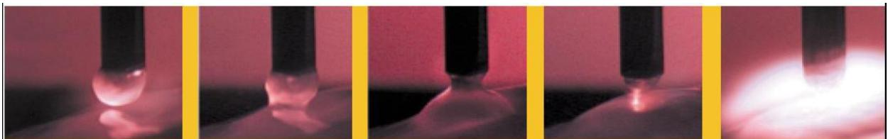
*Slika 9.1 Slijed odvajanja kapljice kod STT postupka zavarivanja [23]*
