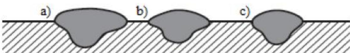
Slika 8.12 Utjecaj brzine zavarivanja na sami oblik, širinu zavara i protaljivanje [18]
