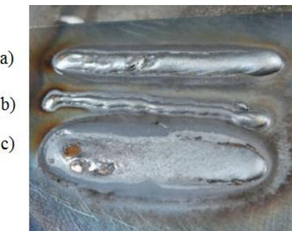
Slika 8.11 Realni prikaz izgleda zavara o zavisnosti na brzinu zavarivanja [22]
