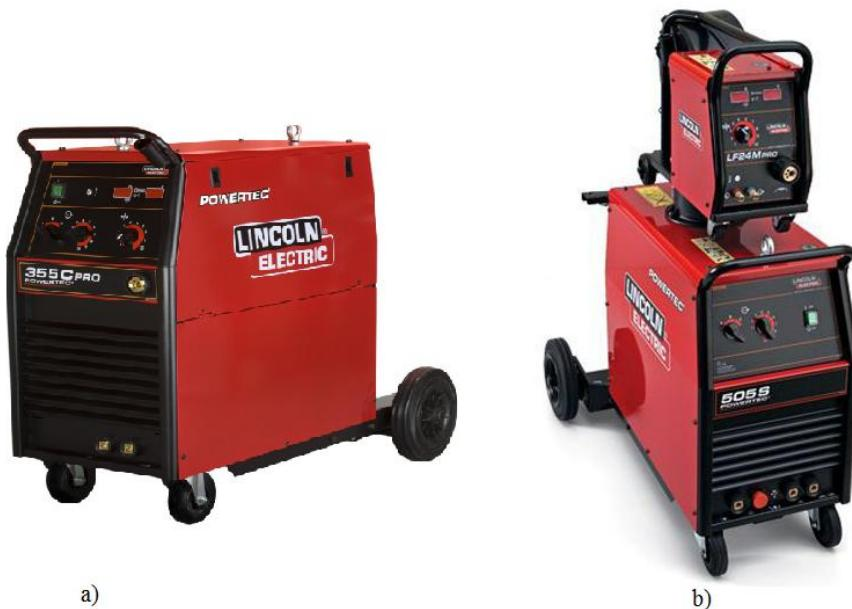
Slika 11.1 a) kompaktni uređaj, b) modularni uređaj
