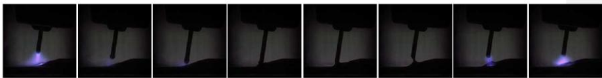
Slika 9.7 Slijed odvajanja kapljice kod CMT postupka [23]
