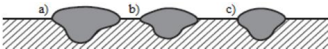
Slika 8.12 Utjecaj brzine zavarivanja na sami oblik, širinu zavora i protaljivanje [18]
