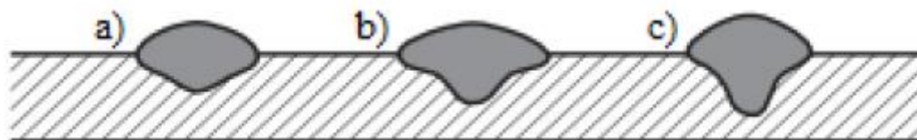
Slika 8.7 Utjecaj jakosti struje na zavar [18]
