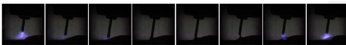
Slika 9.7 Slijed odvajanja kapljice kod CMT postupka [23]
