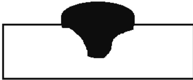
Slika 6.1 Utjecaj zaštitnog plina argona na geometriju zavara
