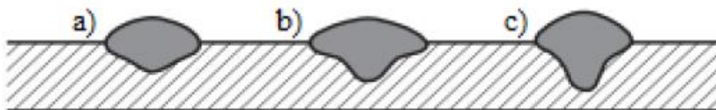
Slika 8.7 Utjecaj jakosti struje na zavar [18]
