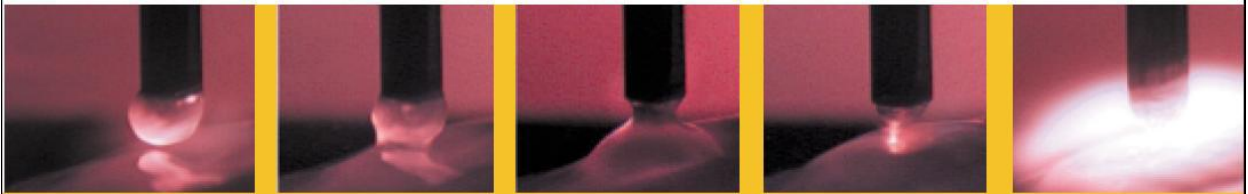
Slika 9.1 Slijed odvajanja kapljice kod STT postupka zavarivanja [23]
