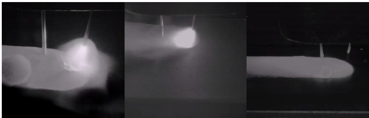
Slika 10.3 Realni prikaza prijenosa metala kod tandem zavarivanja [29]
