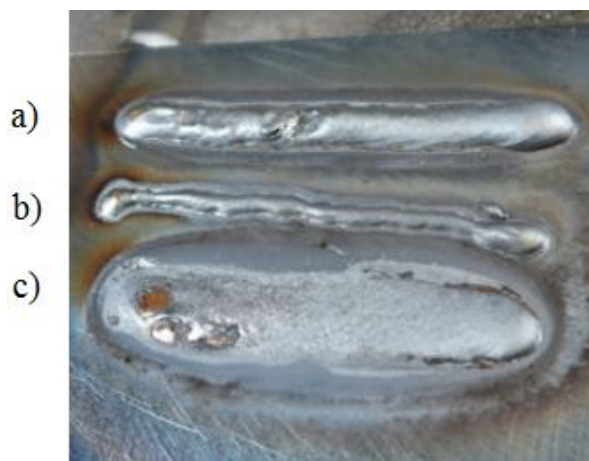
Slika 8.11 Realni prikaz izgleda zavora o zavisnosti na brzinu zavarivanja [22]
