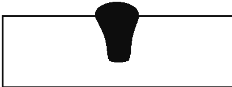
Slika 6.3 Utjecaj zaštitnog plina ugljičnog dioksida na geometriju zavora
