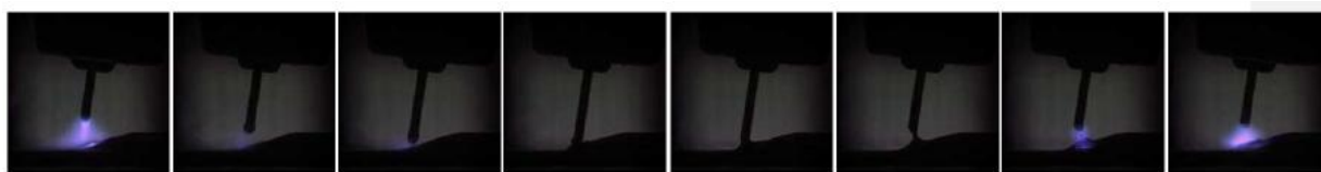
Slika 9.7 Slijed odvajanja kapljice kod CMT postupka [23]
