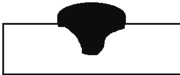
Slika 6.1 Utjecaj zaštitnog plina argona na geometriju zavora
