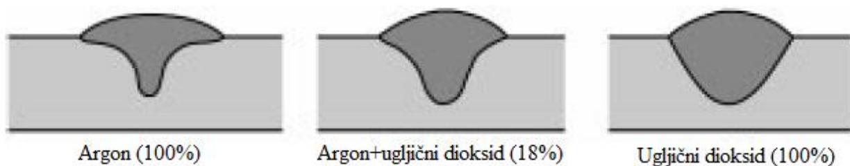
Slika 6.4 Profil penetracije i prodiranje kod smjese plinova argon/ugljični dioksid [15]
