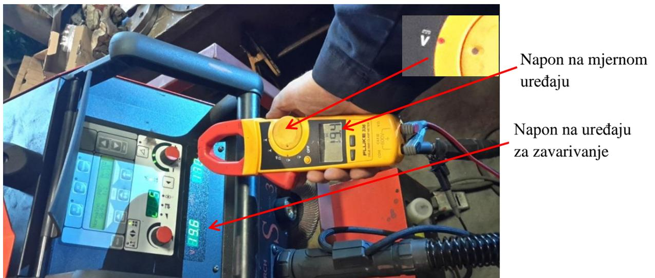
Slika 6.6. Mjerenje napona zavarivanja
