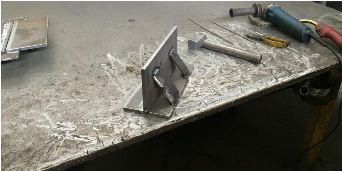
Slika 5.9. Spoj ispitnih ploča za kutni zavar
