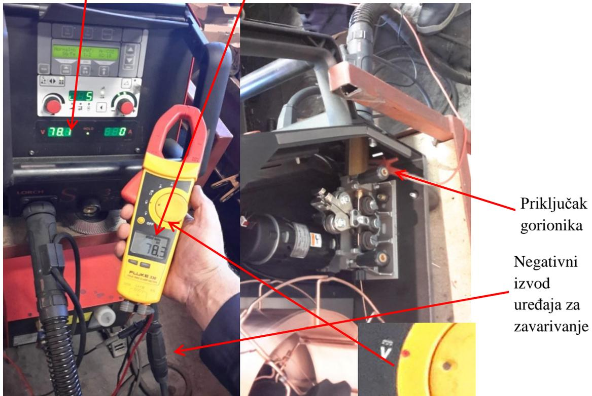
Slika 6.5. Mjerenje napona praznog hoda
