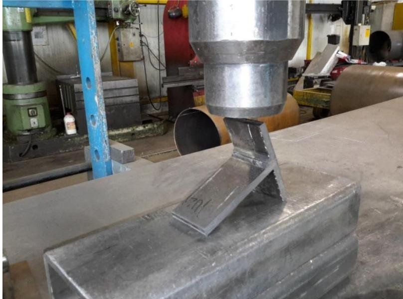
Slika 5.27. Ispitivanje loma – početak ispitivanja
