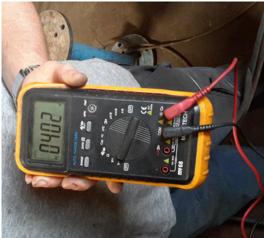
Slika 6.3. Mjerenje napona mreže
