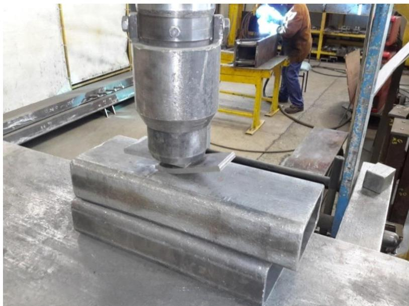
Slika 5.28. Ispitivanje loma – završetak ispitivanja
