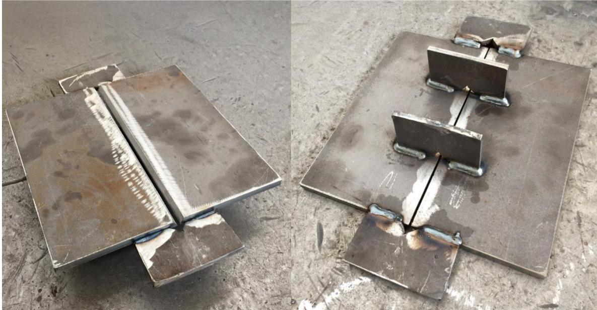
Slika 5.8. Spoj ispitnih ploča za sučeoni zavar
