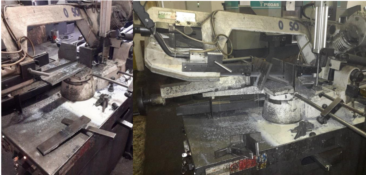
Slika 5.19. Rezanje ispitnih uzoraka
