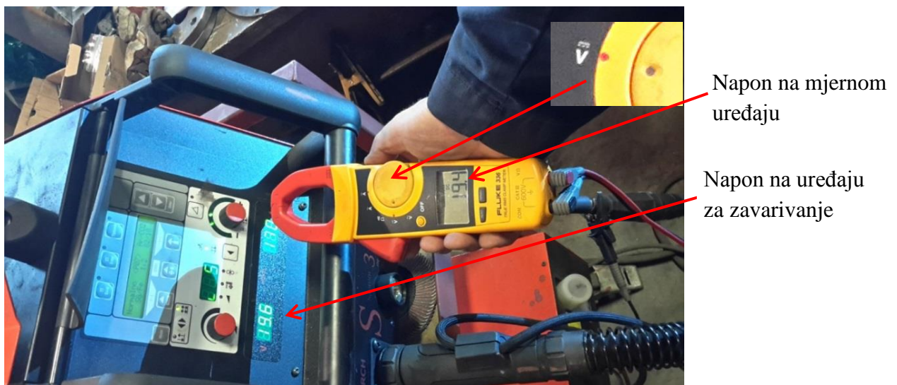
Slika 6.6. Mjerenje napona zavarivanja
