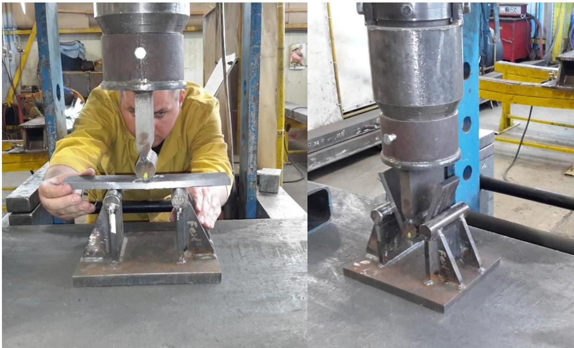
Slika 5.24. Ispitivanje savijanjem sa strane korijena zavara
