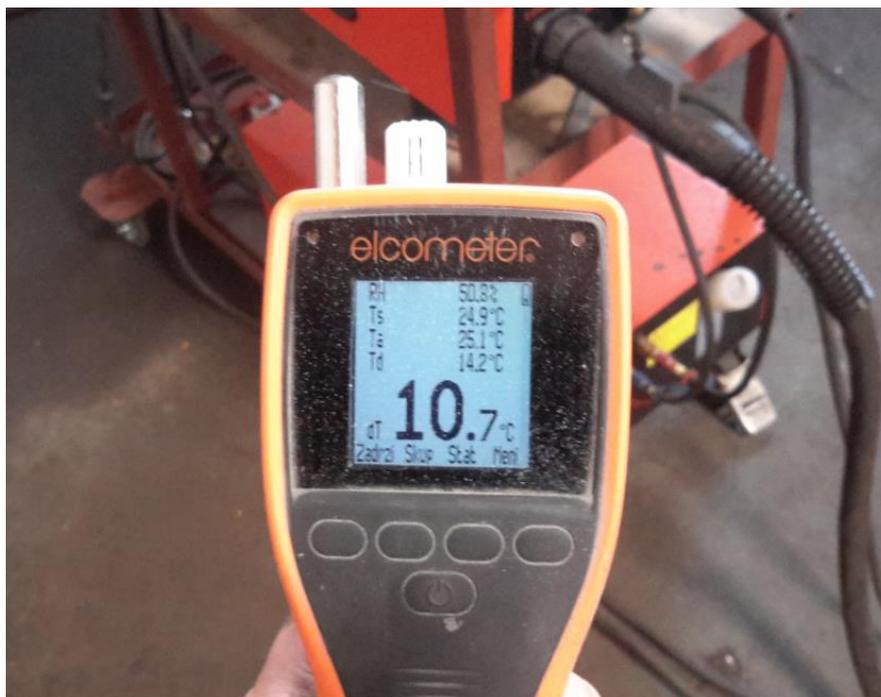
Slika 6.2. Mjerenje temperature i relativne vlažnosti okoline
