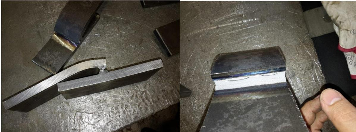
Slika 5.29. Prelomljeni ispitni uzorak
