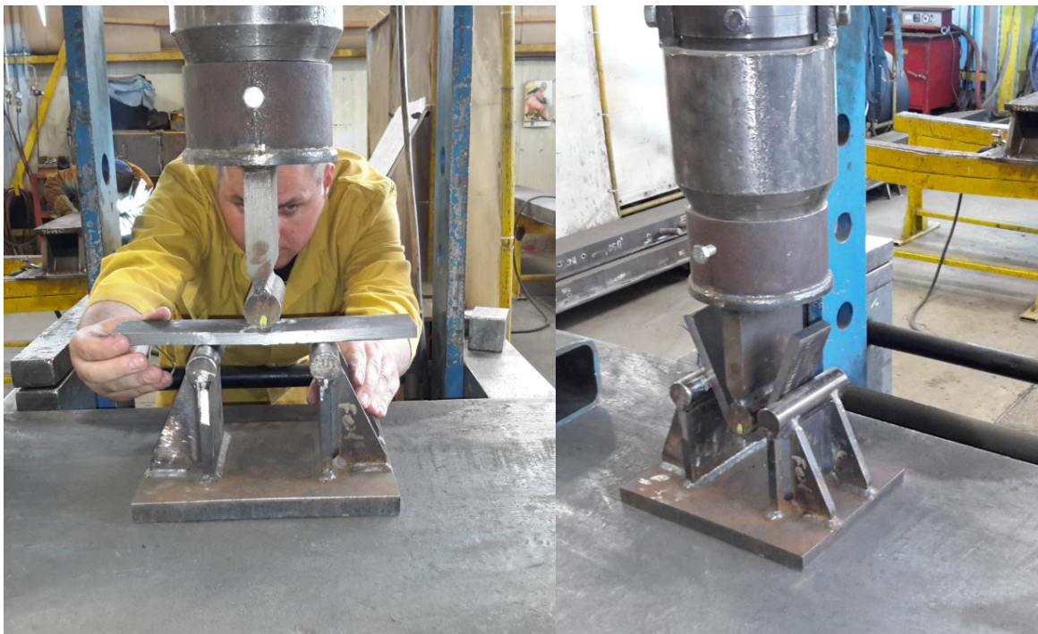
Slika 5.24. Ispitivanje savijanjem sa strane korijena zavara
