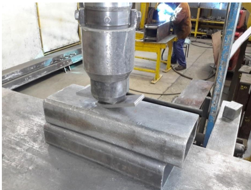
Slika 5.28. Ispitivanje loma – završetak ispitivanja
