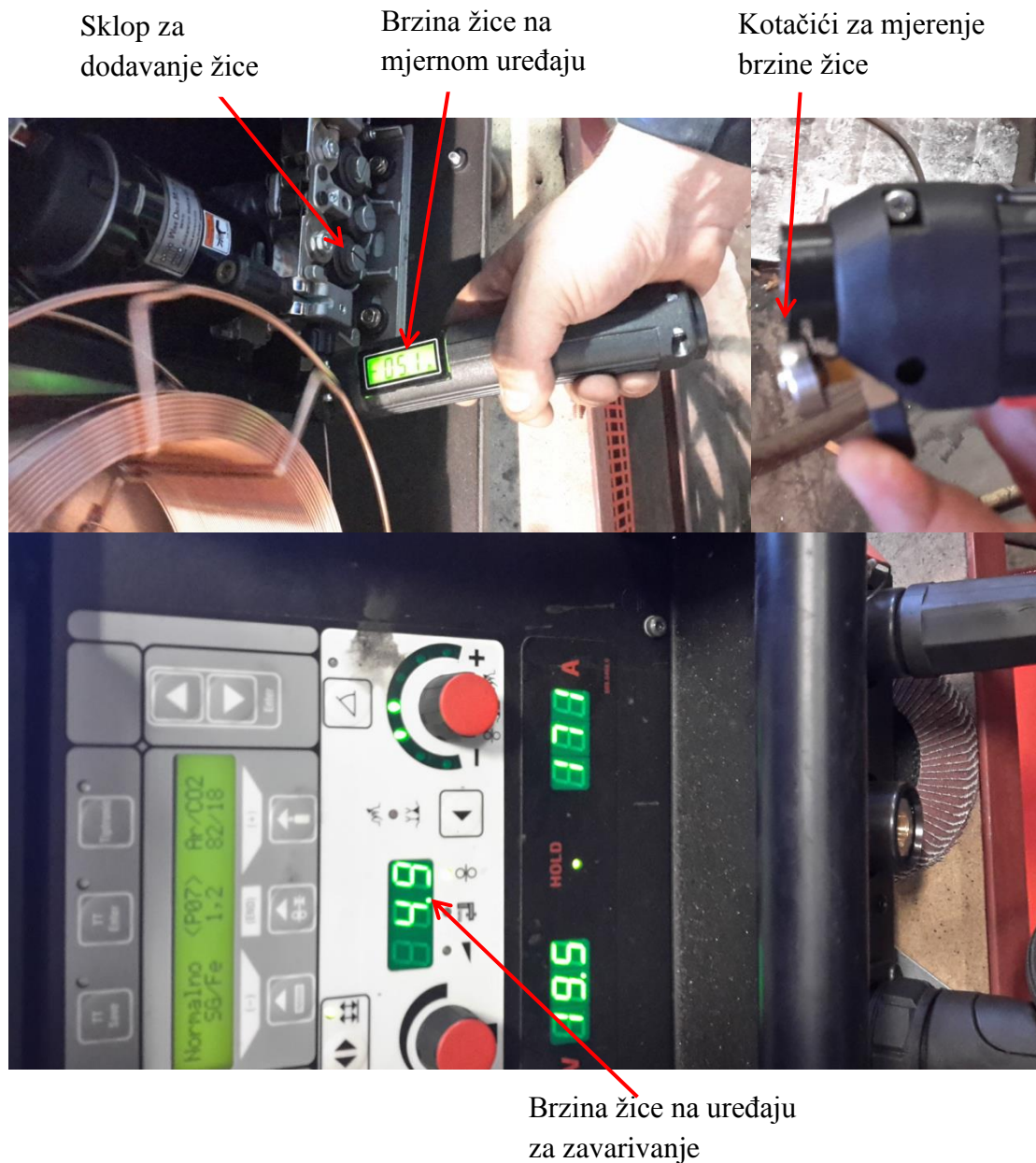
Slika 6.8. Mjerenje brzine žice
