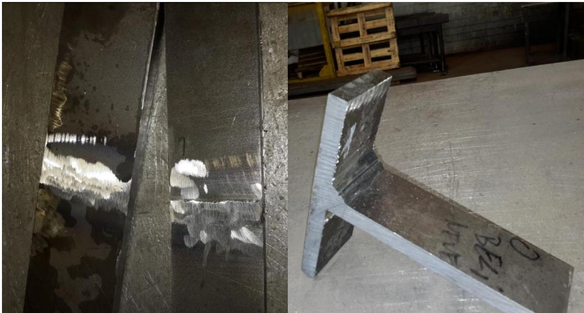
Slika 5.20. Pripremljeni ispitni uzorci za ispitivanje
