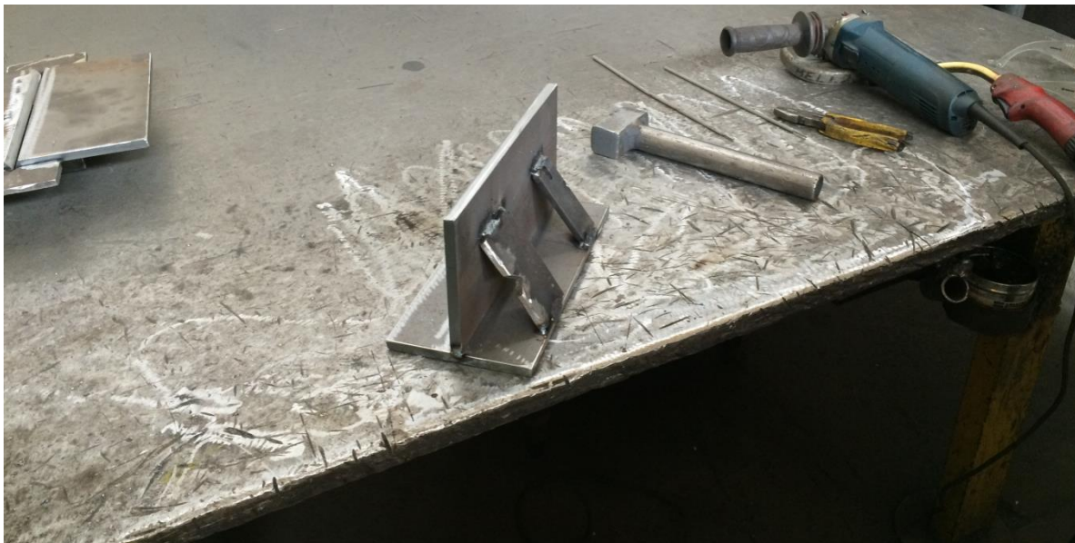
Slika 5.9. Spoj ispitnih ploča za kutni zavar
