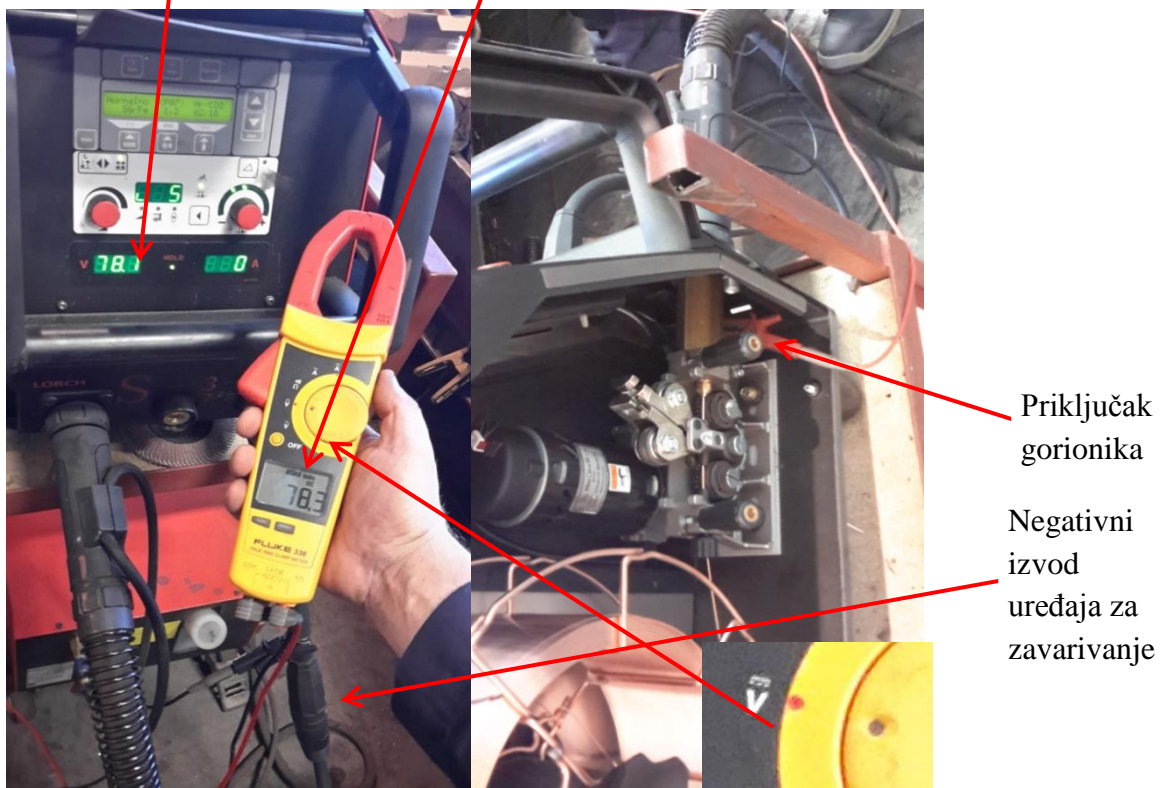
Slika 6.5. Mjerenje napona praznog hoda
