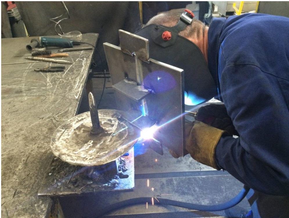
Slika 5.10. Zavarivanje sučeonog zavora
