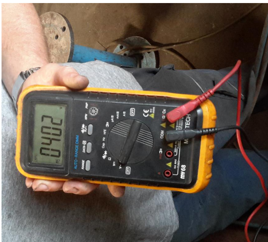
Slika 6.3. Mjerenje napona mreže
