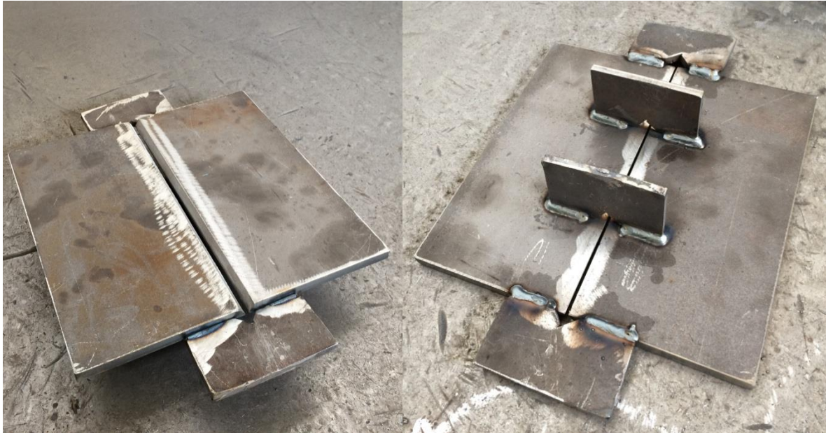
Slika 5.8. Spoj ispitnih ploča za sučeoni zavar
