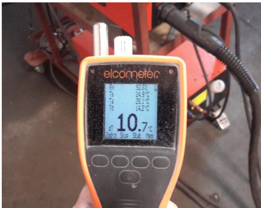
Slika 6.2. Mjerenje temperature i relativne vlažnosti okoline
