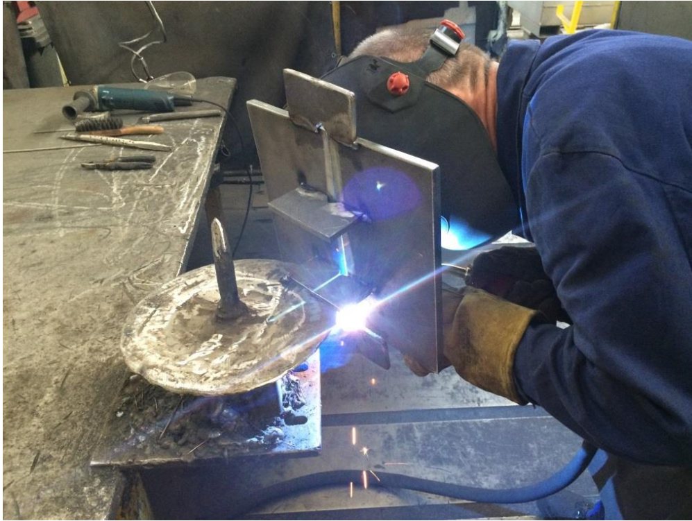
Slika 5.10. Zavarivanje sučeonog zavora
