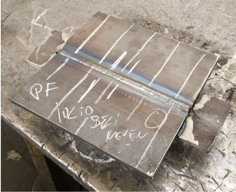
Slika 5.2. Sučeoni zavar na ploči (dužina 300 mm, debljina materijala 12 mm)
