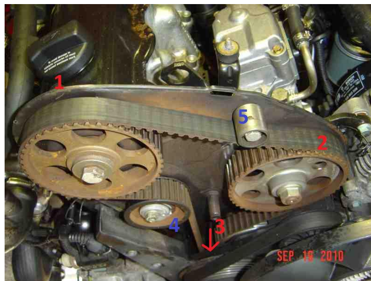
Slika 3.5.1 Izgled zupčastog remena na 1.9 TDI motoru
