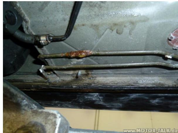
*Slika 5.2.1 Korodirana kočiona cijev*
