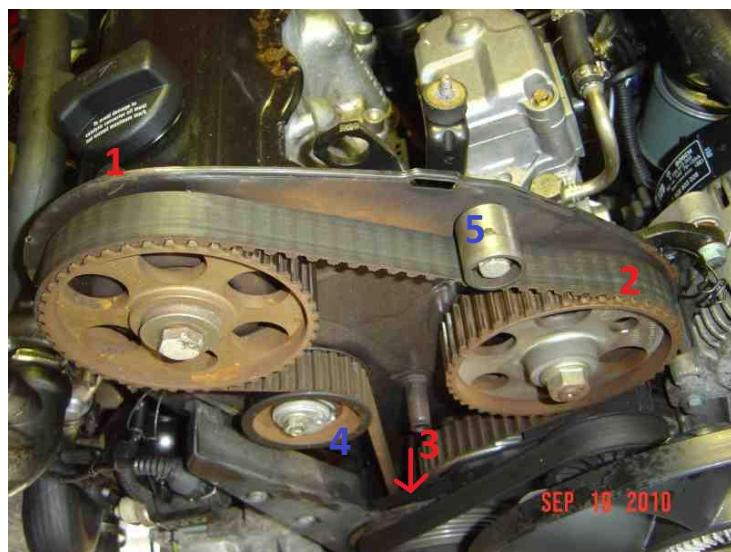
*Slika 3.5.1 Izgled zupčastog remena na 1.9 TDI motoru*
