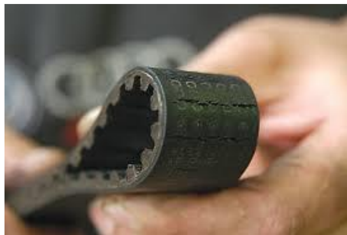
Slika 3.5.4 Dotrajali zupčasti remen
