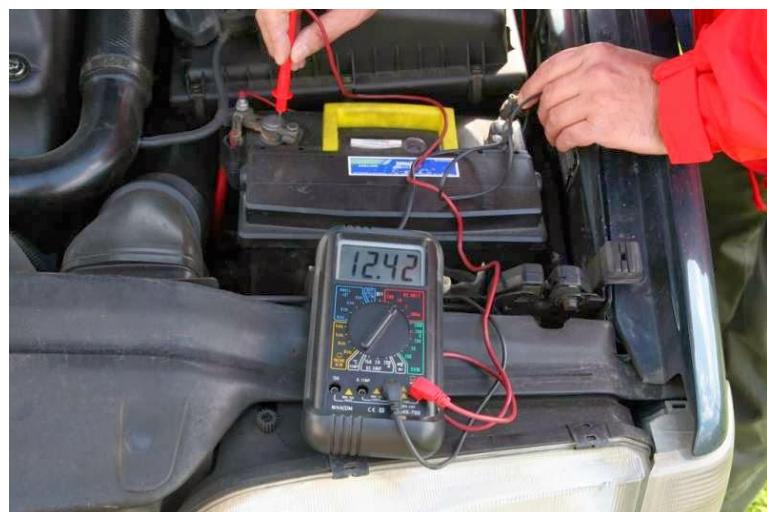
*Slika 3.8.1 Ispitivanje akumulatora*
