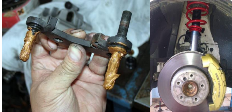
Slika 5.6.1 Podmazan i očišćen kočioni sustav
