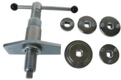
*Slika 10.2.3 Alat za potiskivanje kočionog cilindra*
