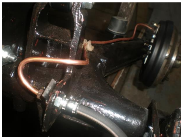
Slika 5.3.1 Izmjenjena metalna i fleksibilna cijev
