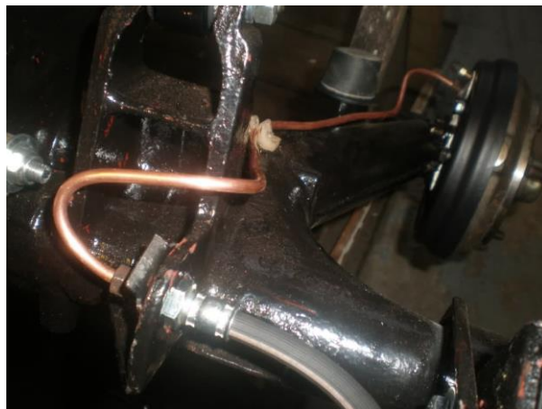
Slika 5.3.1 Izmjenjena metalna i fleksibilna cijev
