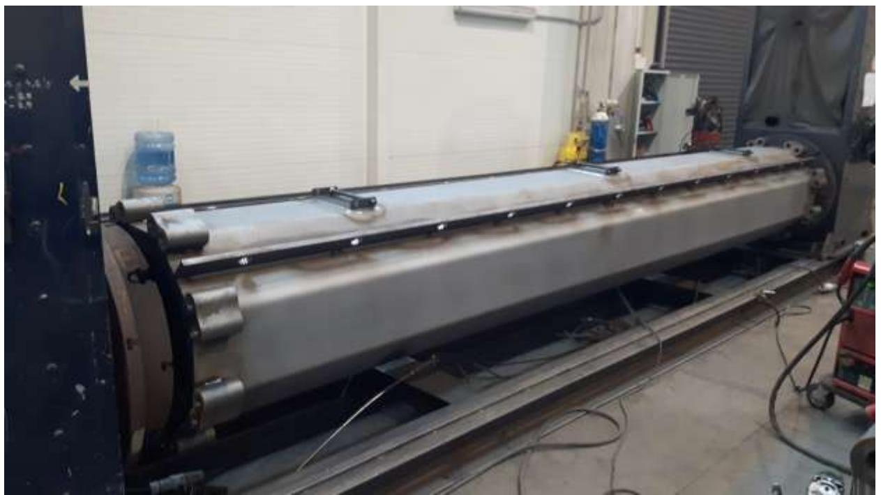
*Slika 3.7.2. Naprava za pozicioniranje konstrukcije*
