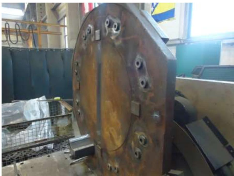
*Slika 3.6.2 Naprava za međusobno pozicioniranje komponenata*
