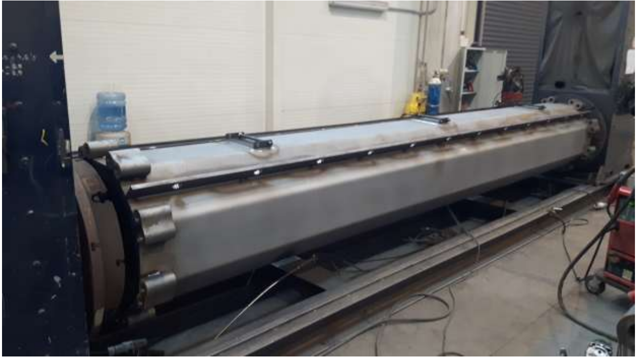
Slika 3.7.2. Naprava za pozicioniranje konstrukcije
