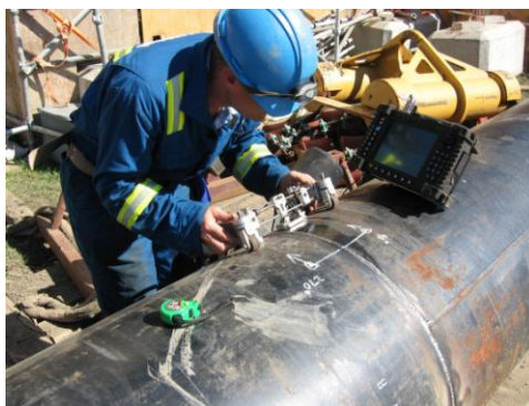
Slika 20. Primjer ultrazvučnog ispitivanja zavarenog spoja na cijevi
