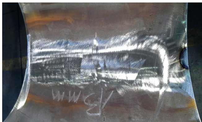
Slika 36. Zavareni spoj nakon brušenja
