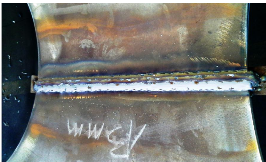
Slika 35. Zavareni spoj prije brušenja
