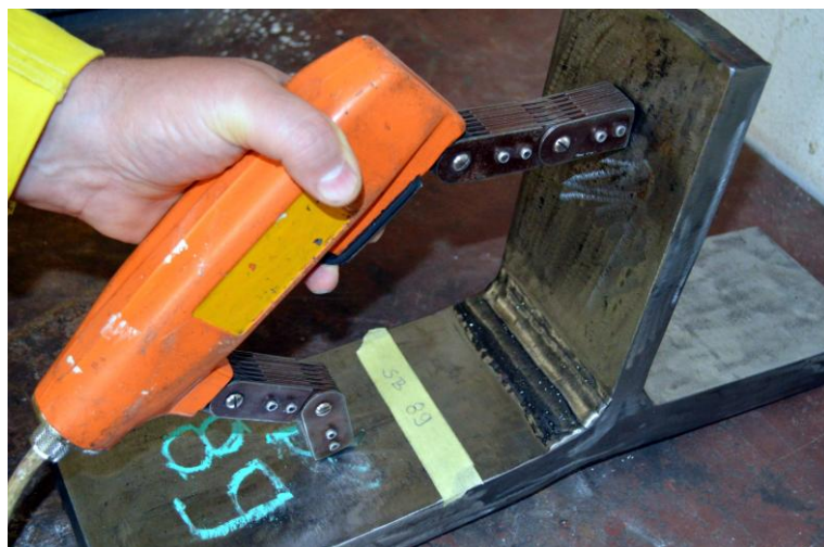
Slika 19. Tehnika ispitivanja strujnim prolazom pomoću dvije elektrode
