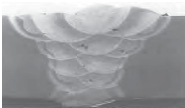
Slika 10. Uključci troske u zavarenom spoju kod MAG zavarivanja [1]
