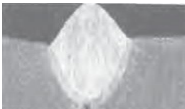
Slika 13. Preveliko nadvišenje zavora [1]
