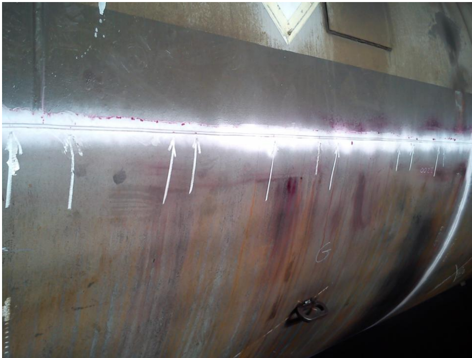
Slika 31. Mrlje na razvijaču koje označuju nepravilnosti
