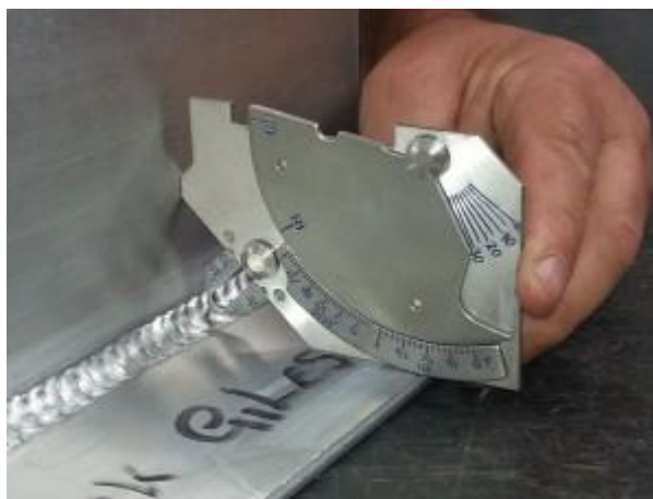
Slika 14. Primjer vizualne kontrole uz pomoć mjerila
