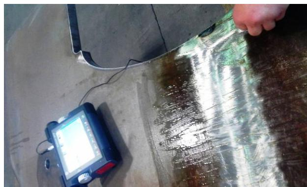
Slika 37. Priprema zavarenog spoja za ultrazvučno ispitivanje
