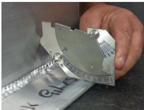
Slika 14. Primjer vizualne kontrole uz pomoć mjerila
