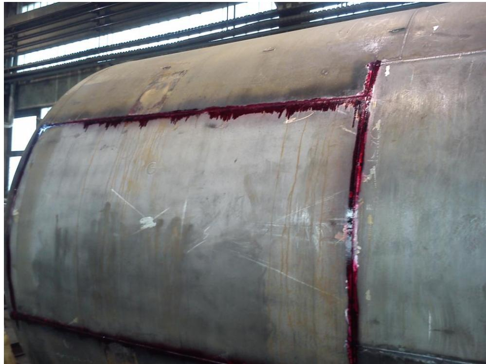
*Slika 29. Naneseni penetrant na zavarenim spojevima*
