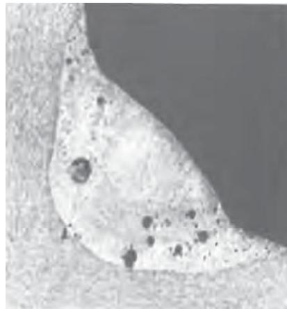
*Slika 9. Poroznost u zavarenom spoju kod MIG zavarivanja aluminija [1]*
