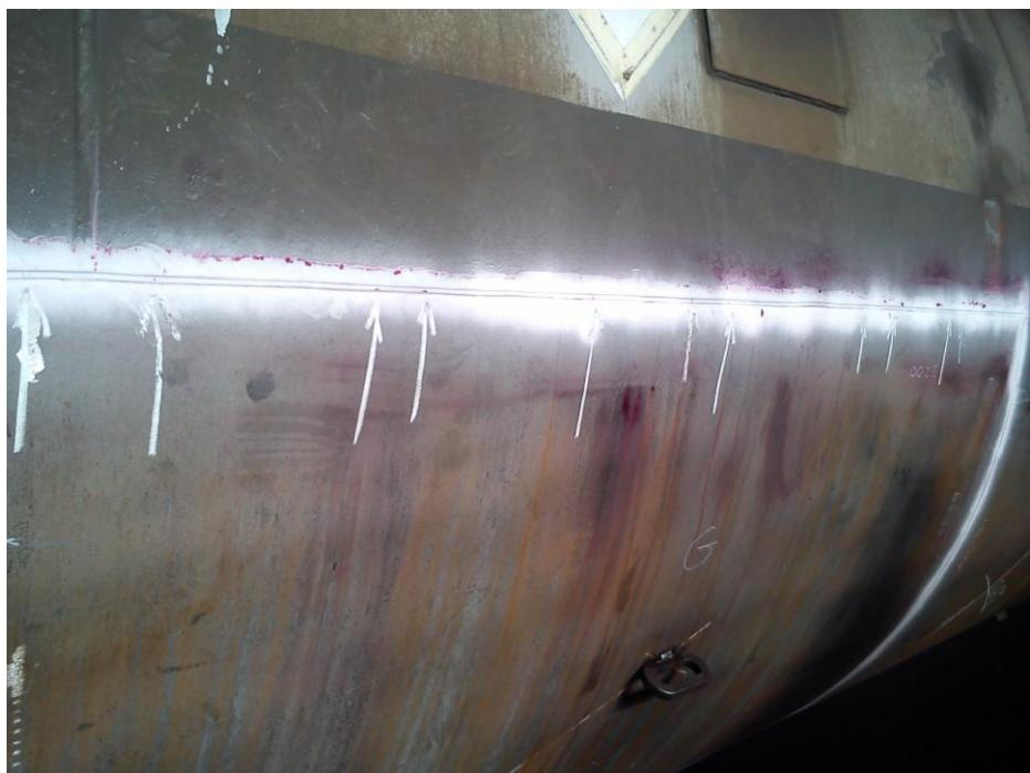
Slika 31. Mrlje na razvijajuću koje označuju nepravilnosti
