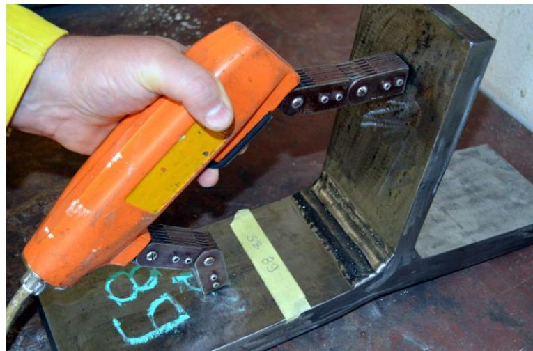
Slika 19. Tehnika ispitivanja strujnim prolazom pomoću dvije elektrode
