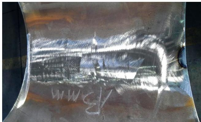
Slika 36. Zavareni spoj nakon brušenja
