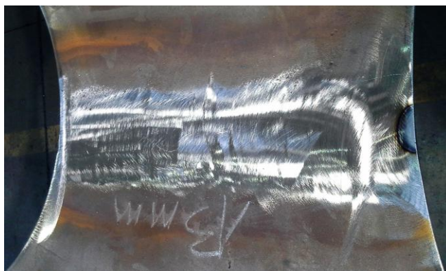
Slika 36. Zavareni spoj nakon brušenja
