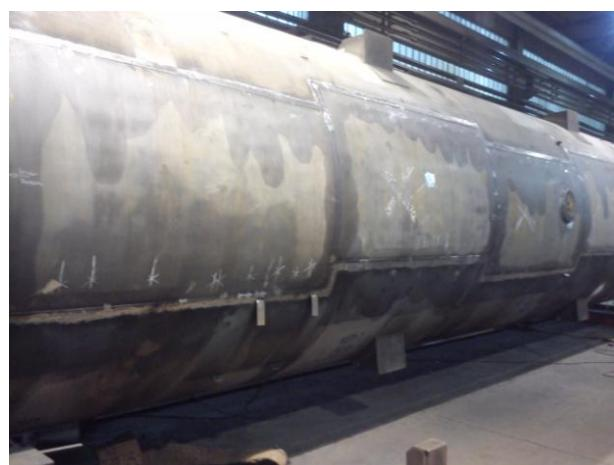
Slika 28. Očišćene površine zavarenih spojeva
