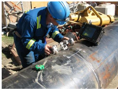
*Slika 20. Primjer ultrazvučnog ispitivanja zavarenog spoja na cijevi*
