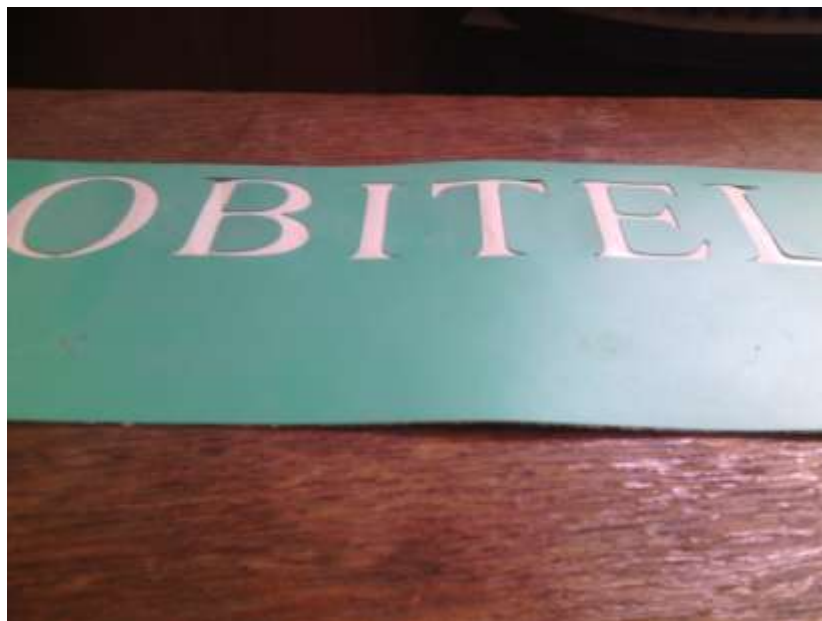
Slika 2.6. Folija za pjeskarenje sa izrezanom željenom gravurom
