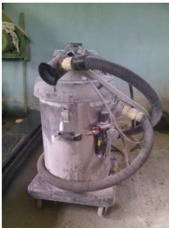
Slika 2.8. Pjeskara sa integriranim usisavačem
