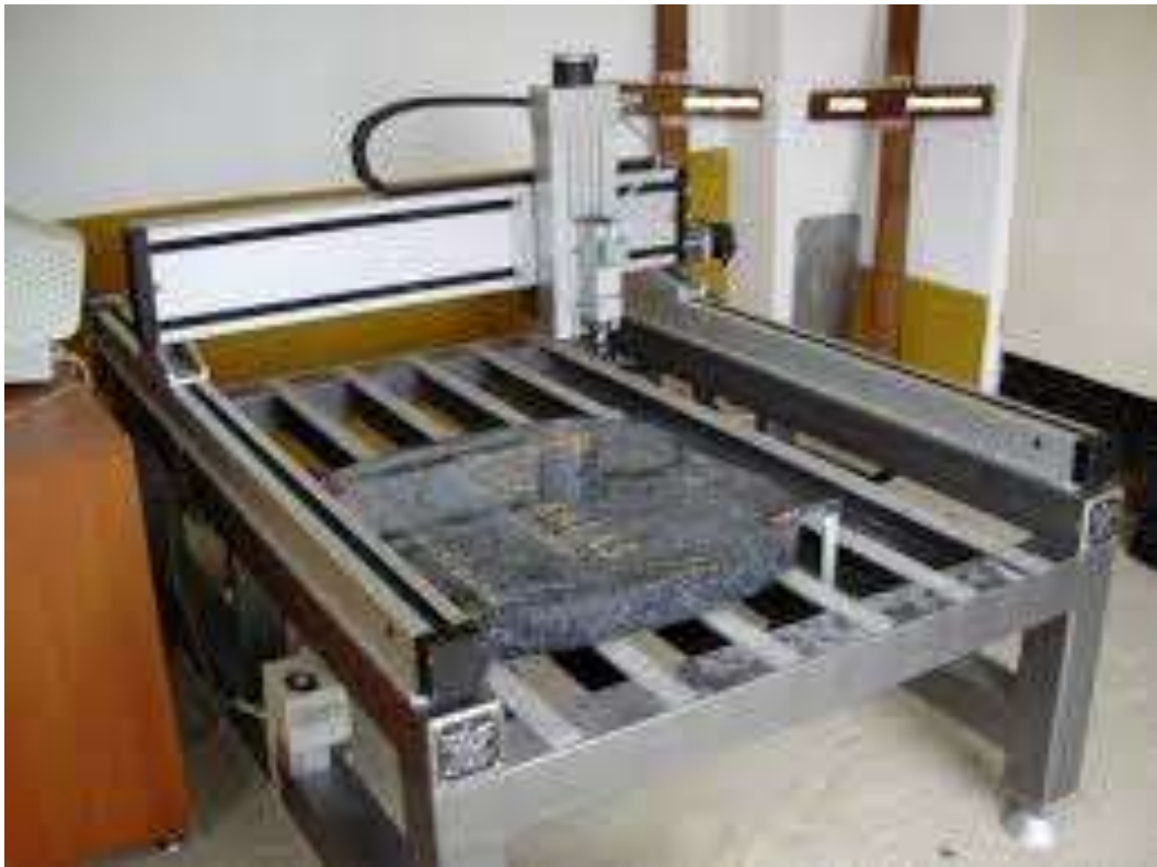
Slika 2.11. Numerički upravljana gravirka za granit
