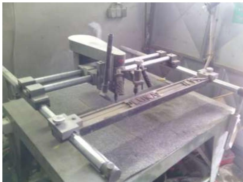
Slika 2.9. Ručni stroj za graviranje
