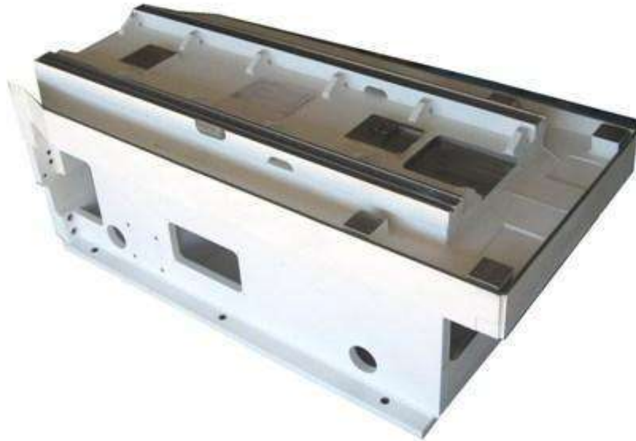
Slika 4.2. Zavarena izvedba postolja stroja
