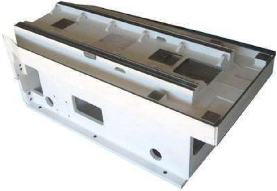
*Slika 4.2. Zavarena izvedba postolja stroja*
