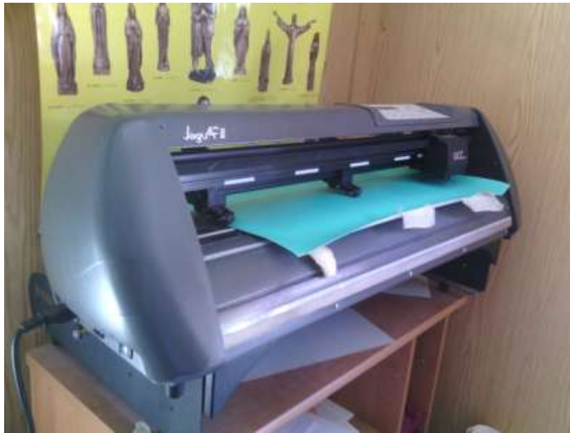
Slika 2.5. Ploter za izrezivanje željene gravure iz folije
