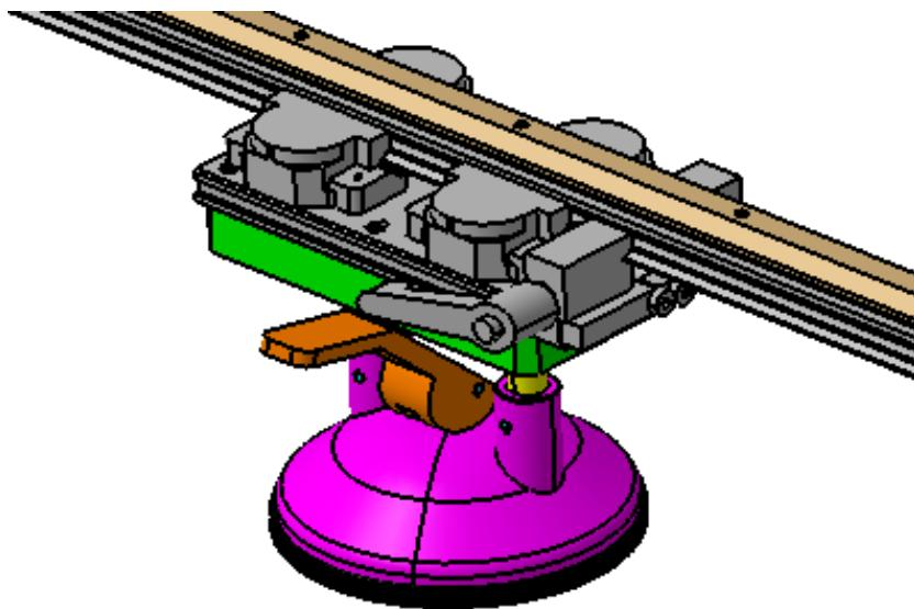
Slika 5.22. Prikaz vakuumskih hvataljka na vodilicama s kočnizom za namještanje
