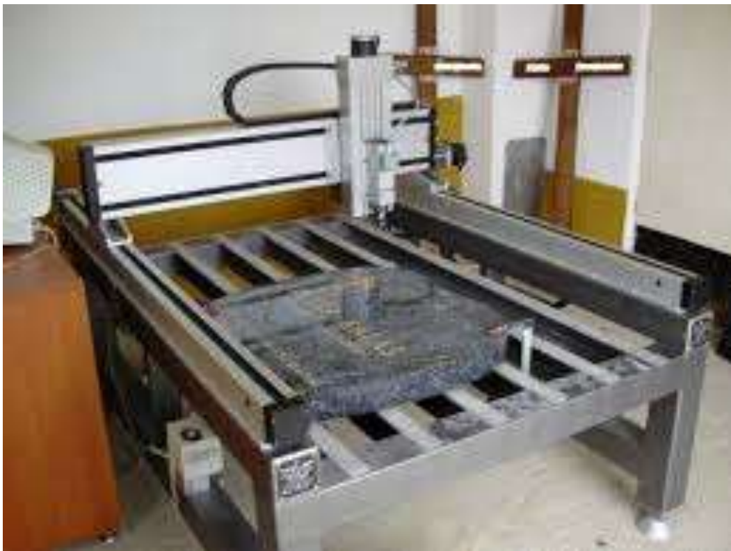
Slika 2.11. Numerički upravljana gravirka za granit
