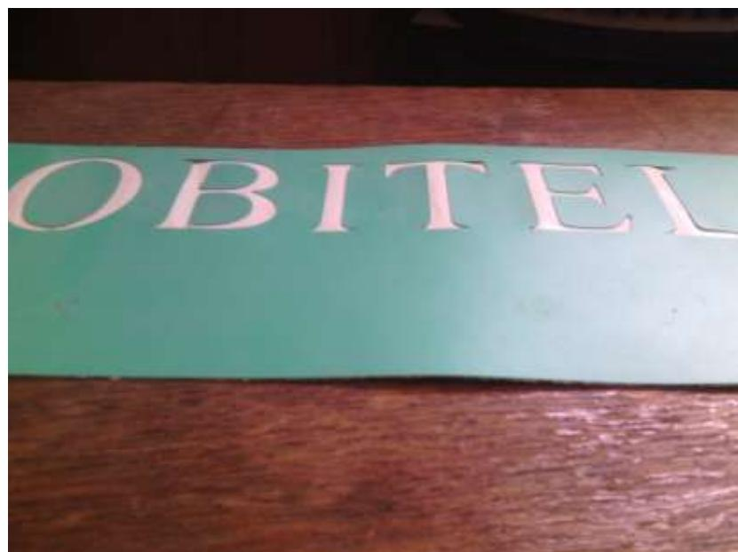
*Slika 2.6. Folija za pjeskarenje sa izrezanom željenom gravirom*
