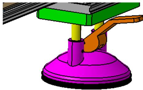
Slika 5.21. Ručne vakuumske stezaljke
