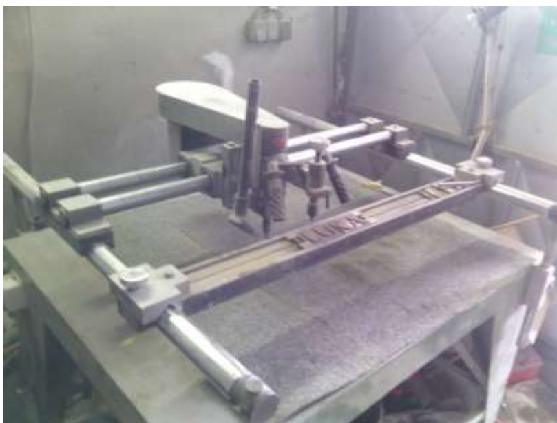
Slika 2.9. Ručni stroj za graviranje
