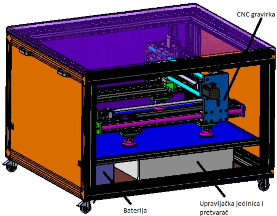
Slika 5.24. Presjek sanduka za transport sa prikazanim dijelovima
