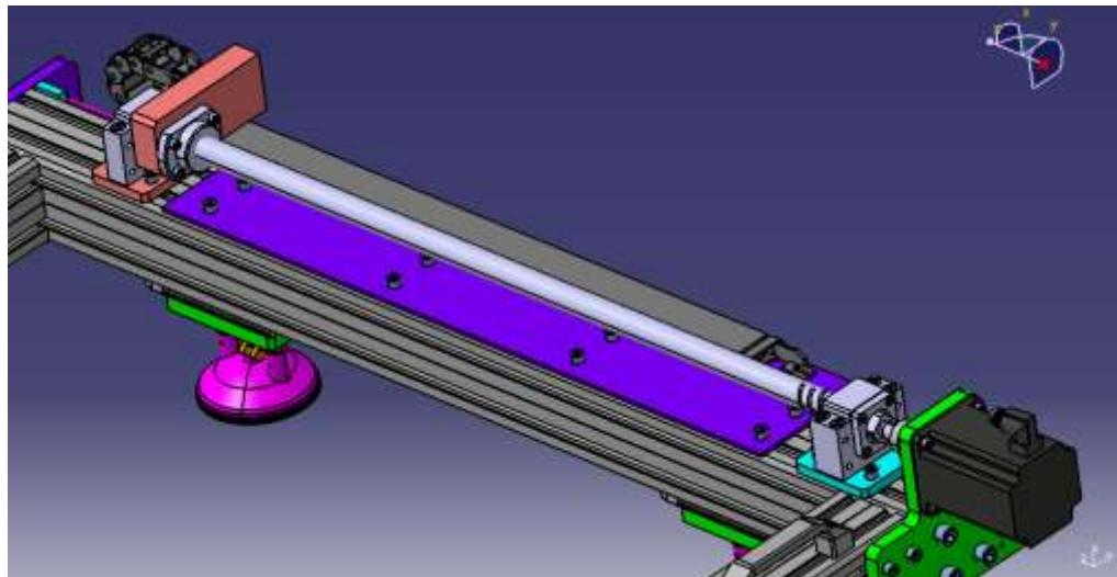
Slika 5.18. Prikaz kugličnog navojnog vretena x-osi
