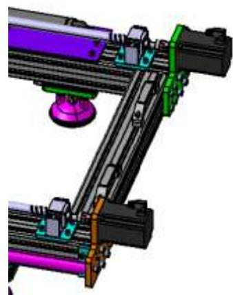
Slika 5.13. Prikaz koračnih motora x-osi
