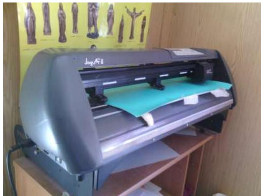
*Slika 2.5. Ploter za izrezivanje željene gravure iz folije*
