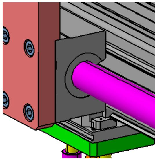
Slika 5.8. Postavljanje linearnih kugličnih ležajeva
