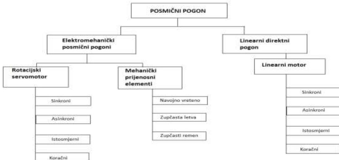
Slika 4.12. Mogući načini realizacije posmičnih pogona
