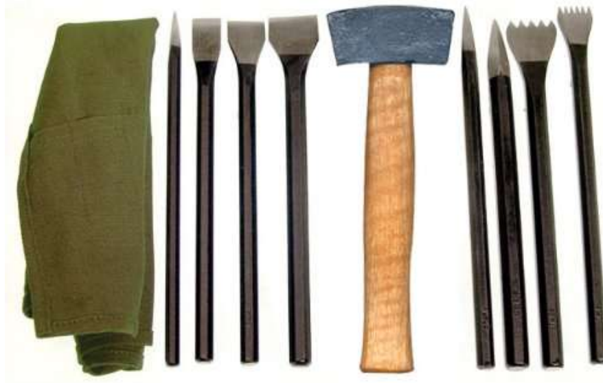
Slika 2.2. Set alata za ručno graviranje (klesanje)
