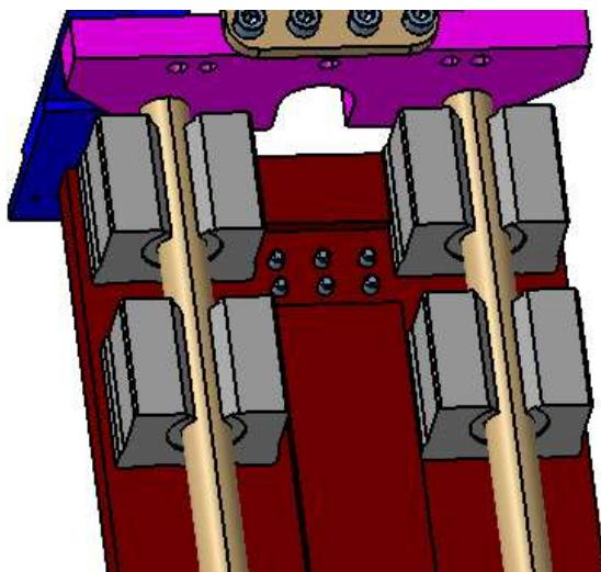
*Slika 5.10. Cilindrične osovine i linearni ležajevi z-osi*
