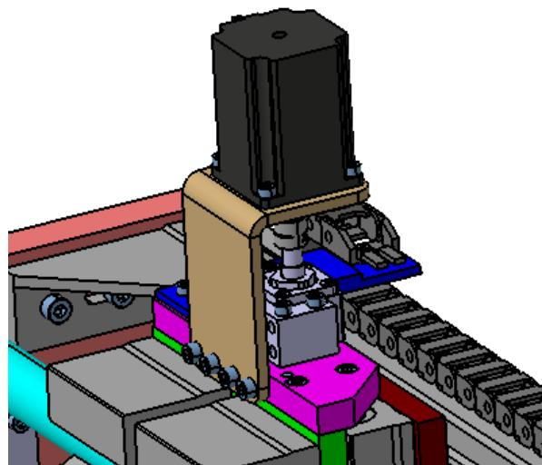
Slika 5.16. Prikaz koračnog motora z-osi
