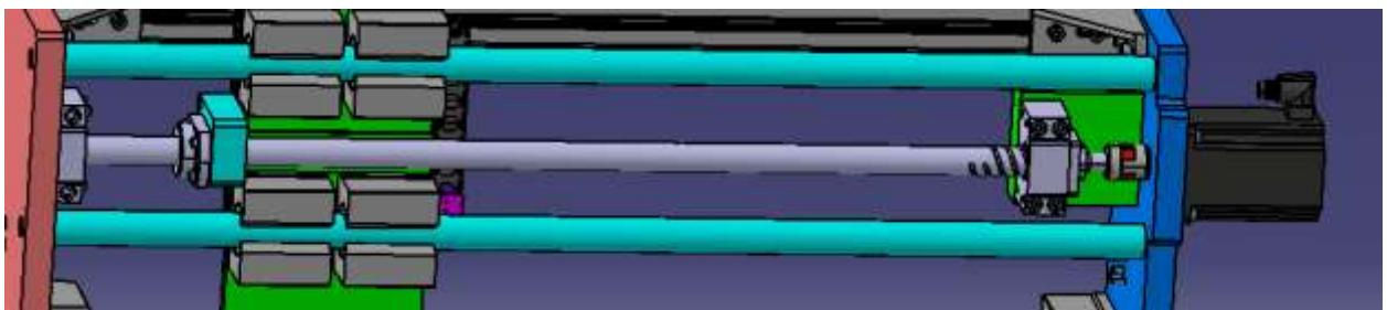
Slika 5.19. Prikaz kugličnog navojnog vretena y-osi
