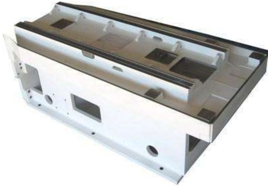
Slika 4.2. Zavarena izvedba postolja stroja
