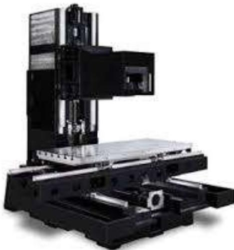
*Slika 4.3. Numerički upravljan stroj s postoljem lijevanim iz sivog lijeva*
