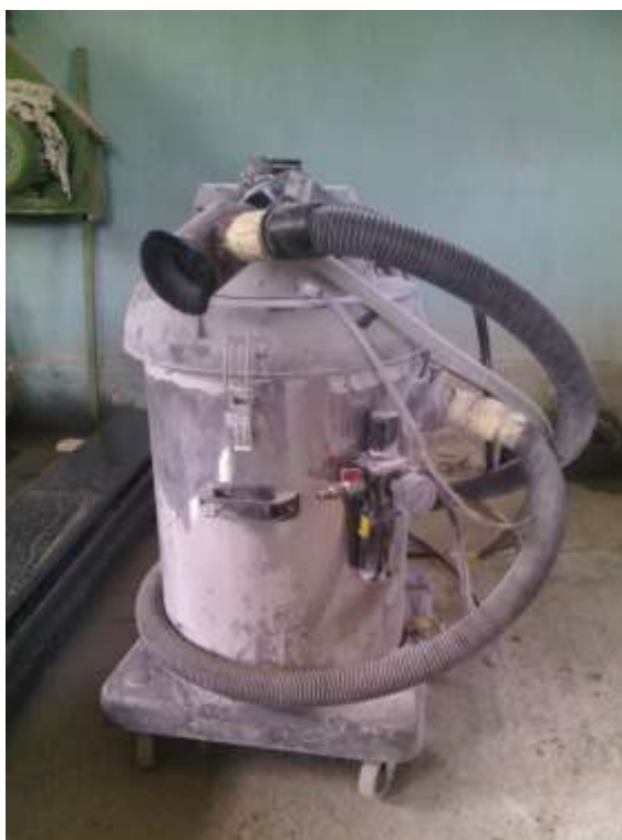
Slika 2.8. Pjeskara sa integriranim usisavačem
