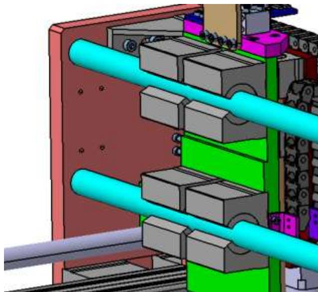
Slika 5.9. Cilindrične osovine i linearni cilindrični ležajevi y-osi
