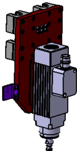
*Slika 5.12. Pričvršćivanje motorvretena na CNC gravirku*
