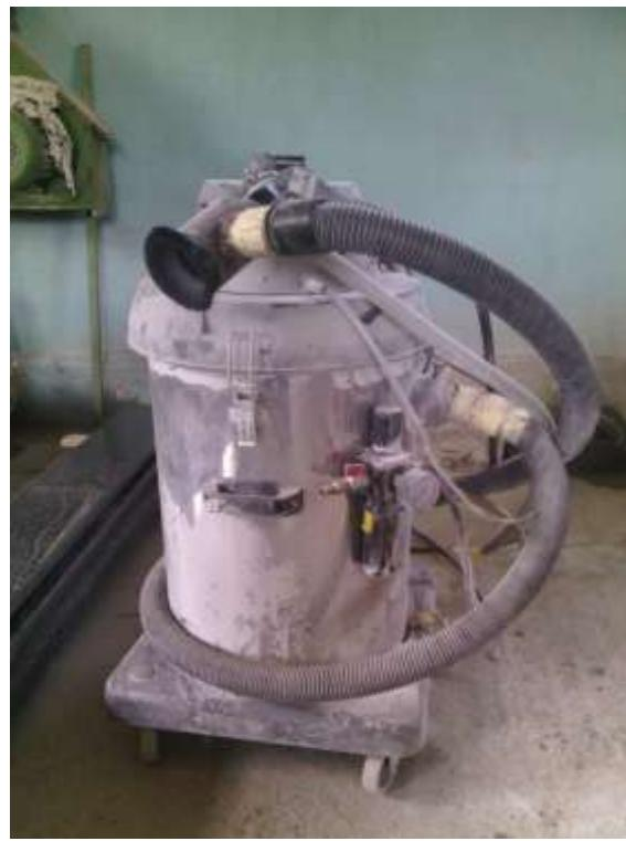
*Slika 2.8. Pjeskara sa integriranim usisavačem*
