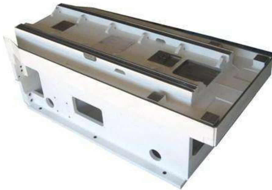
Slika 4.2. Zavarena izvedba postolja stroja
