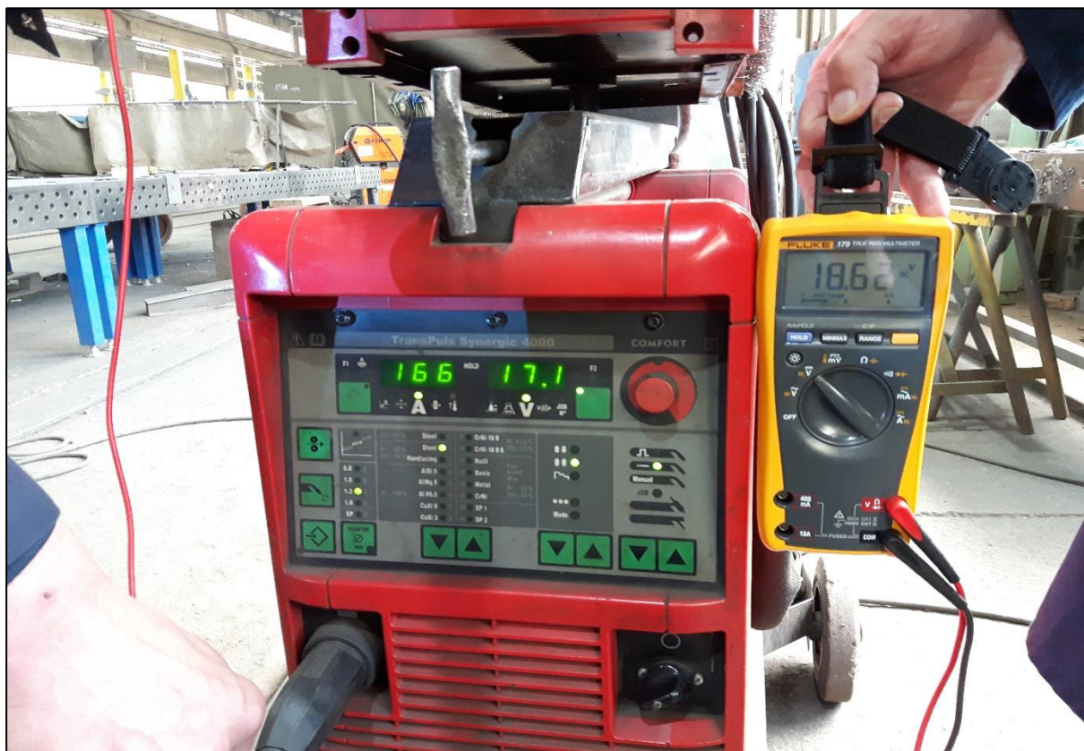
Slika 9.3 Mjerenje napona za vrijeme zavarivanja
