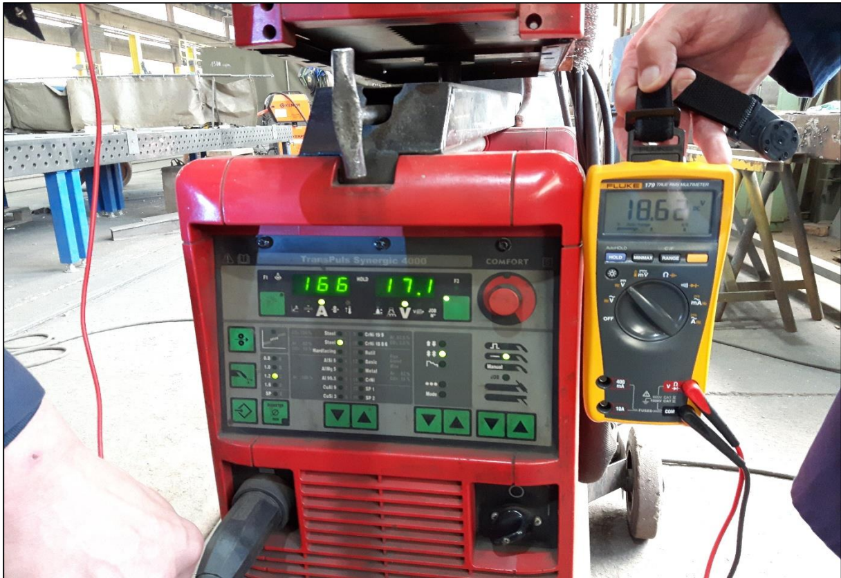
Slika 9.3 Mjerenje napona za vrijeme zavarivanja
