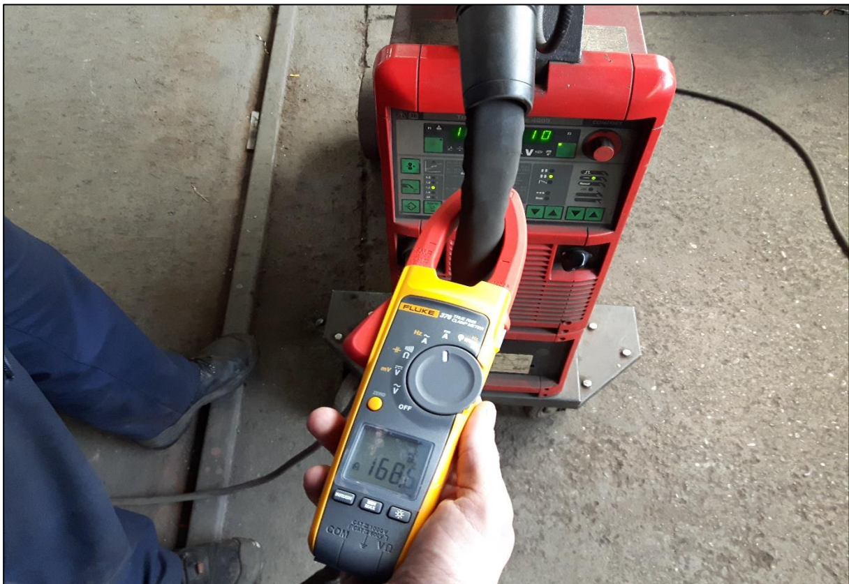
Slika 9.4 Mjerenje struje zavarivanja obuhvatnim ampermetrom (strujnim kliještima)
