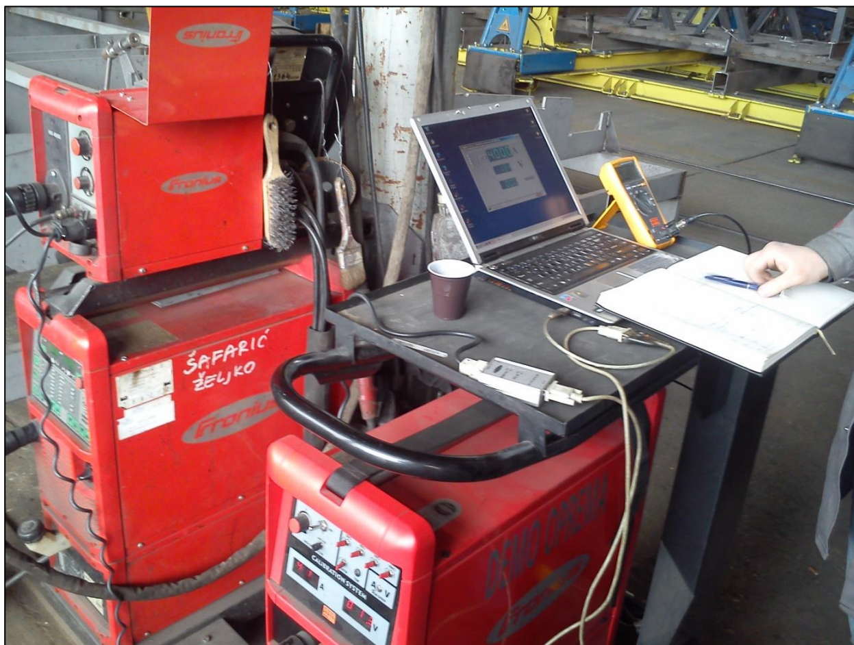
Slika 9.11 Provjera TIG uređaja
