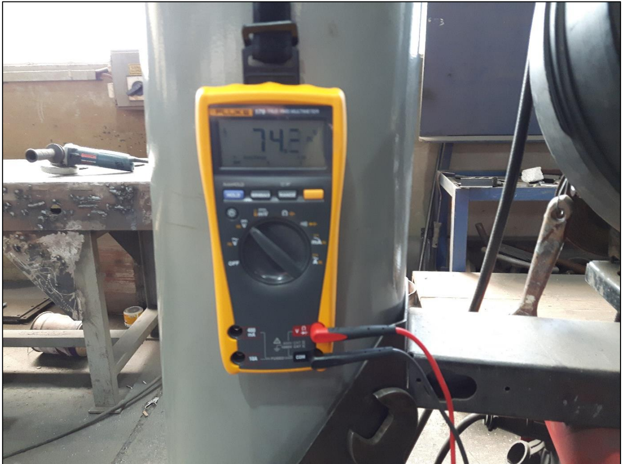
Slika 9.12 Napon praznog hoda uređaja Fronius TPS 4000
