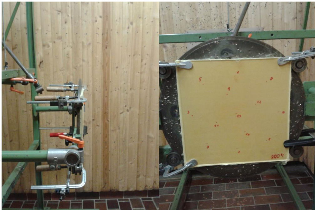
Slika 4.4. Stezanje i namještanje ploče
