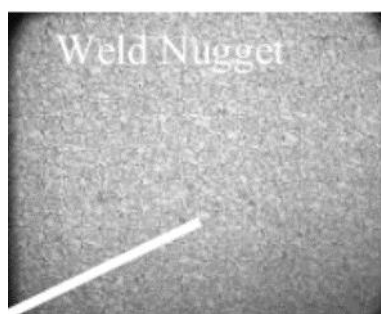
Slika 29 Mikrostruktura "grumen" zone [18]
