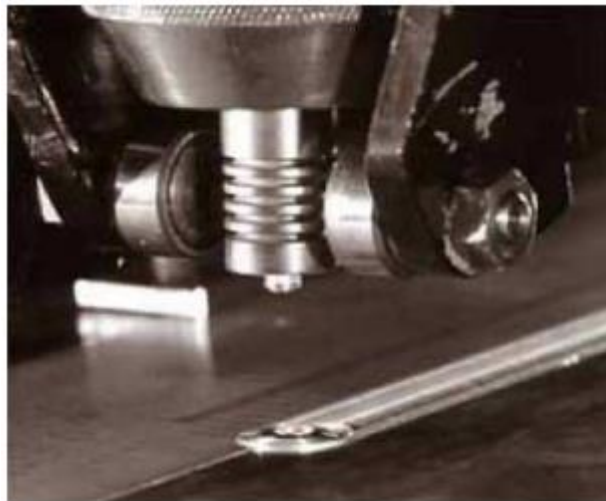
Slika 16 Sistem za kontrolu dubine prodiranja čela alata u materijal koji se sastoji od dva pomoćna valjka [13]
