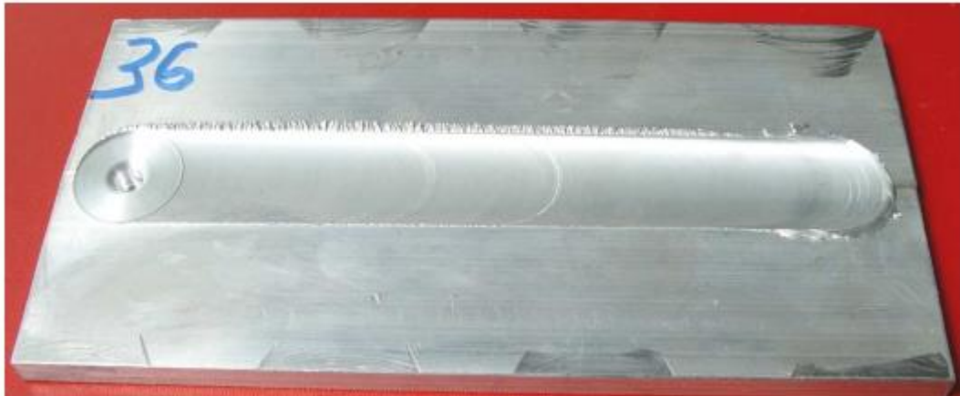
Slika 32 Gornja površina zavara FSW postupkom [13]
