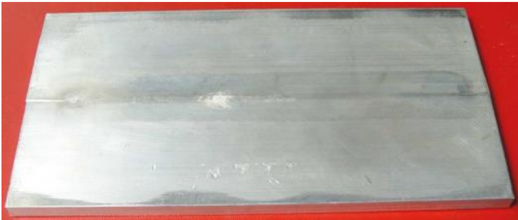
Slika 33 Donja površina zavara FSW postupkom [13]
