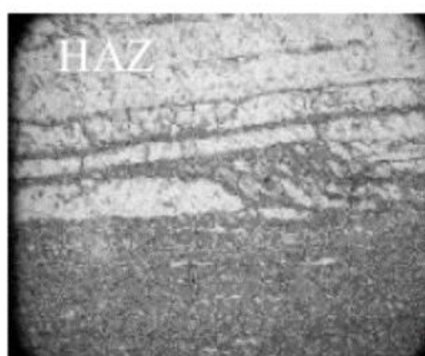
Slika 27 Mikrostruktura zone utjecaja topline [18]
