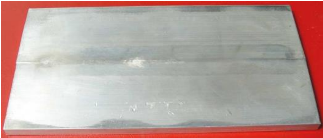
Slika 33 Donja površina zavara FSW postupkom [13]
