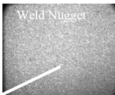
Slika 29 Mikrostruktura "grumen" zone [18]
