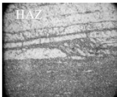
Slika 27 Mikrostruktura zone utjecaja topline [18]
