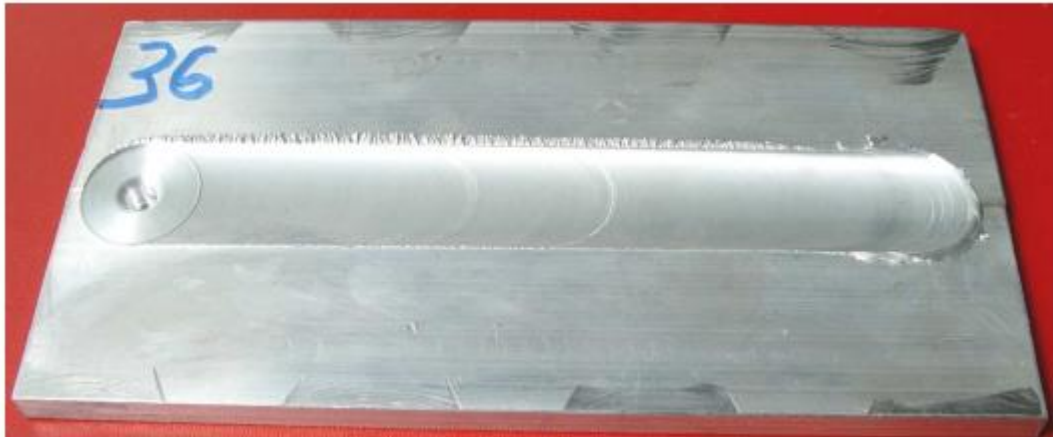
Slika 32 Gornja površina zavara FSW postupkom [13]
