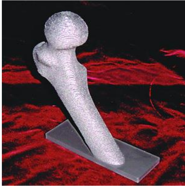
Slika 3.10 Primjer zamjenskog kuka LENS postupkom [32]
