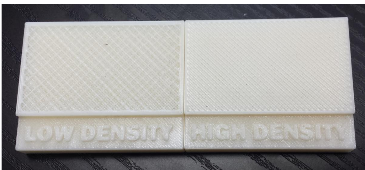
Slika 6.4 Prikaz različitih gustoća ispune materijala
