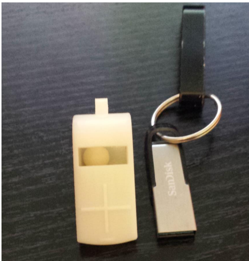
Slika 6.9 konačan proizvod dobiven Dimension Elite printerom
