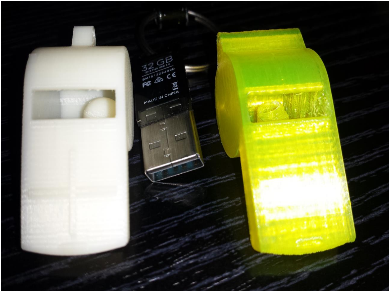
Slika 6.14 Usporedba kvalitete izrade kuglice različitim printerima
