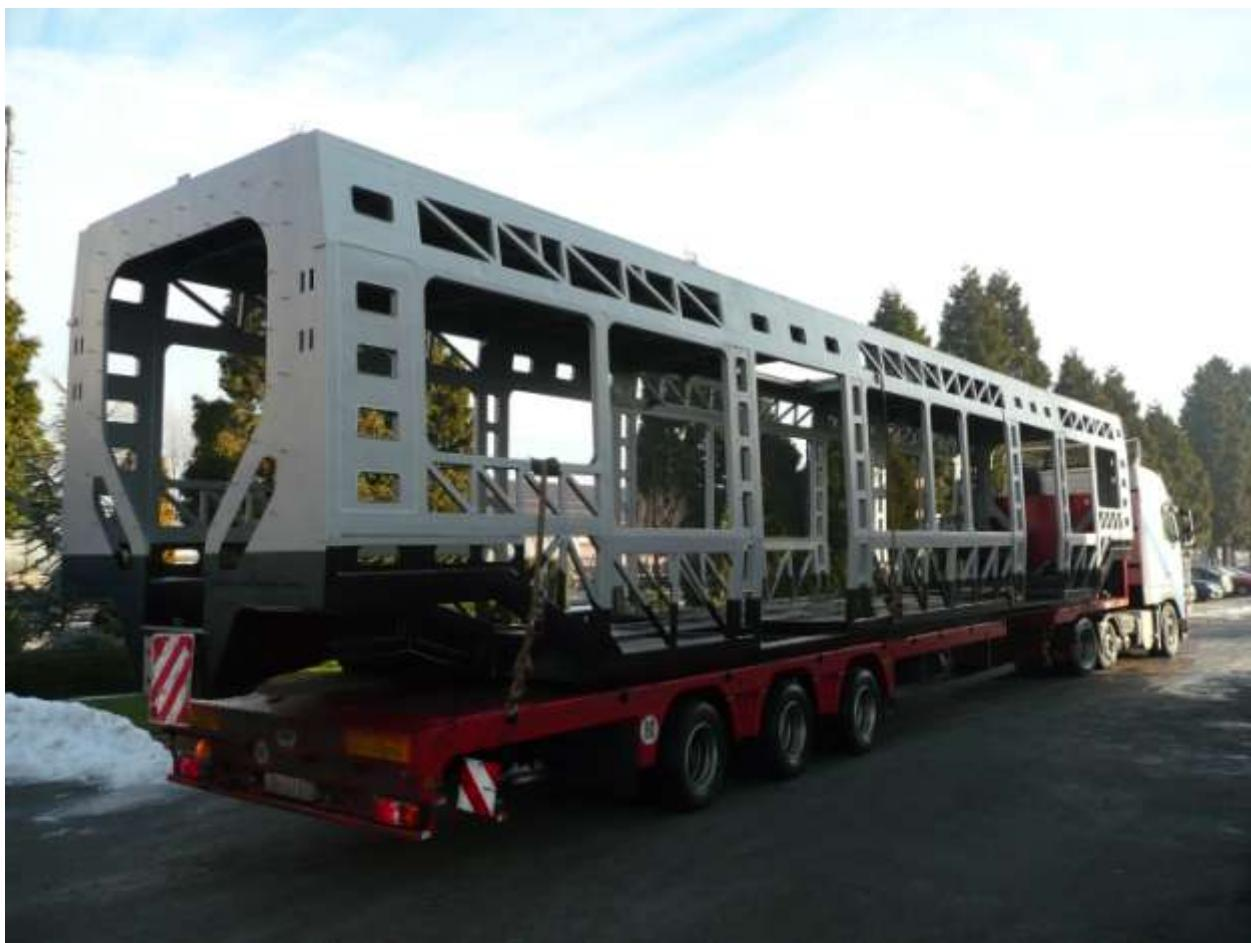
*Slika 6.22 Konačna konstrukcija vagona (Modul C)*
