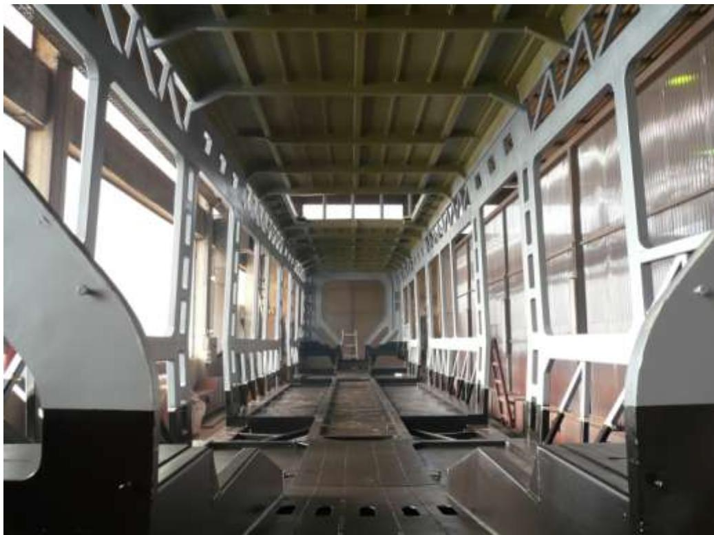
*Slika 6.21 Konstrukcija krova nakon primjene AKZ*
