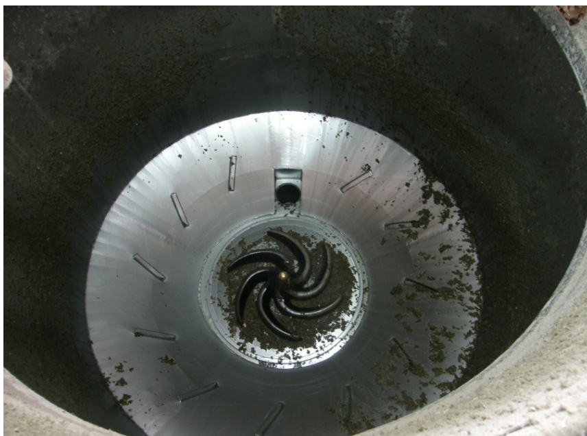
Slika 2.2: Unutrašnjost pulpera sa nožem
