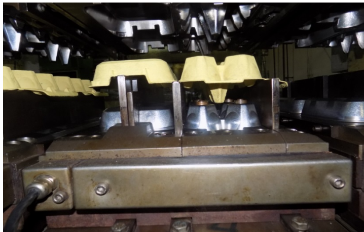
Slika 6.2: Ispravno podešeni podizači
