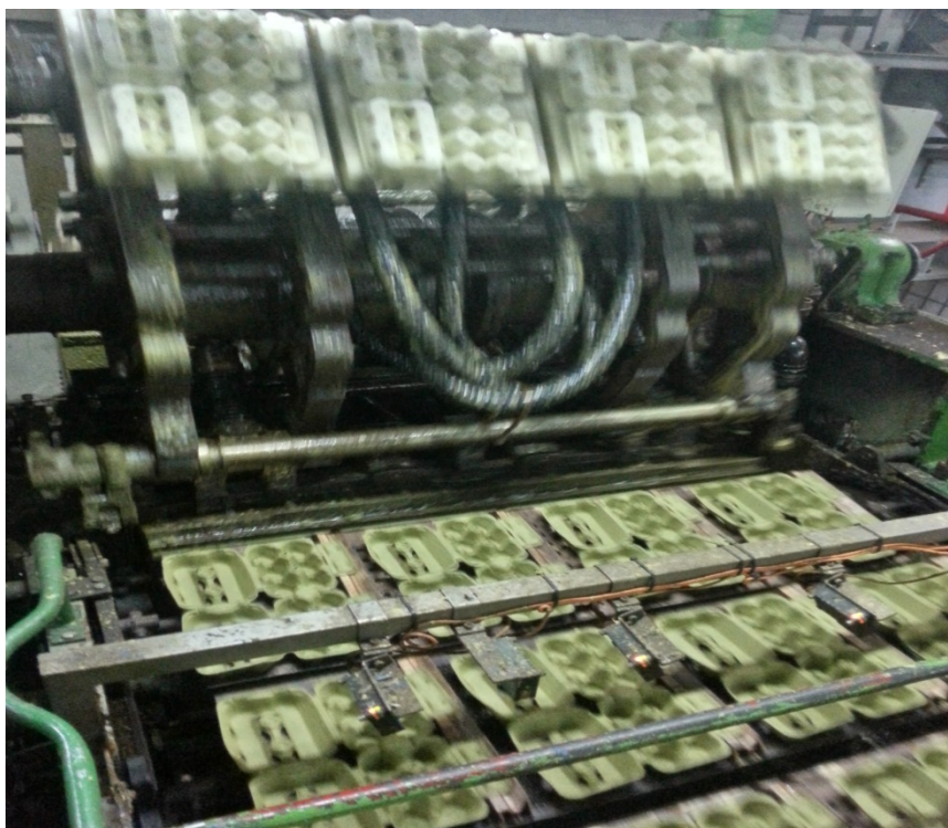
Slika 2.7: Prijenos proizvoda na transportnu traku
