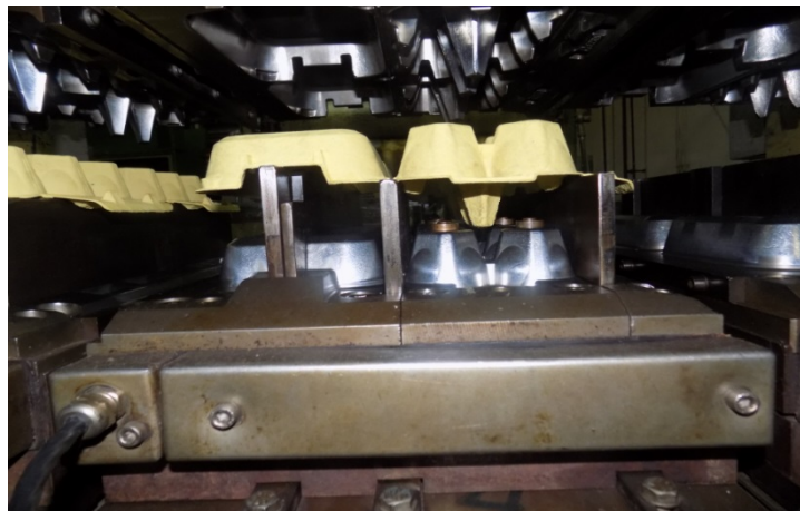
Slika 6.2: Ispravno podešeni podizači
