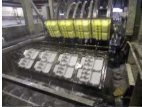
Slika 2.5: Usisni i presni rotor
