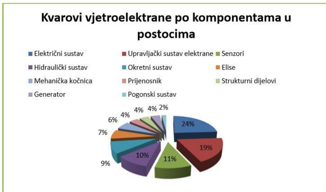
Slika 17 Kvarovi vjetroelektrane po komponentama u postocima
