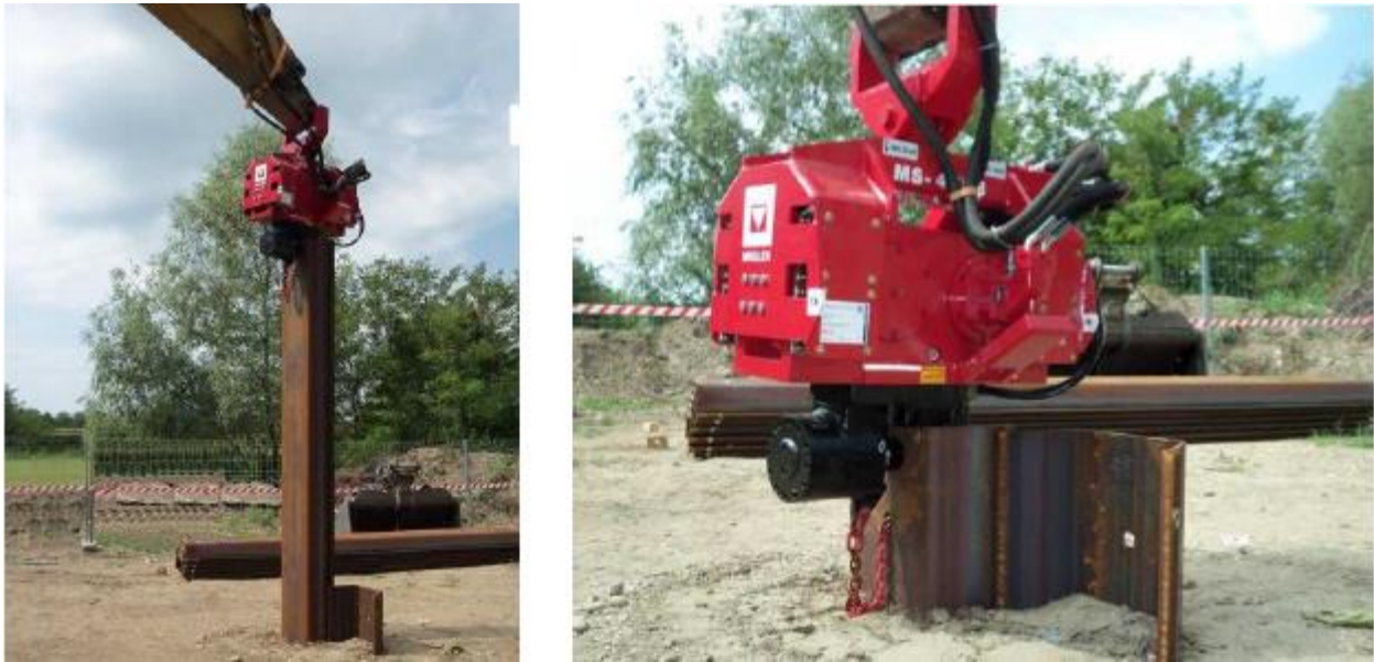
Slika 7. Vibrator za nabijanje i vađenje talpi
