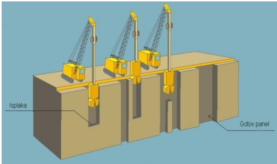
Slika 15. Specijalni stroj za iskop
