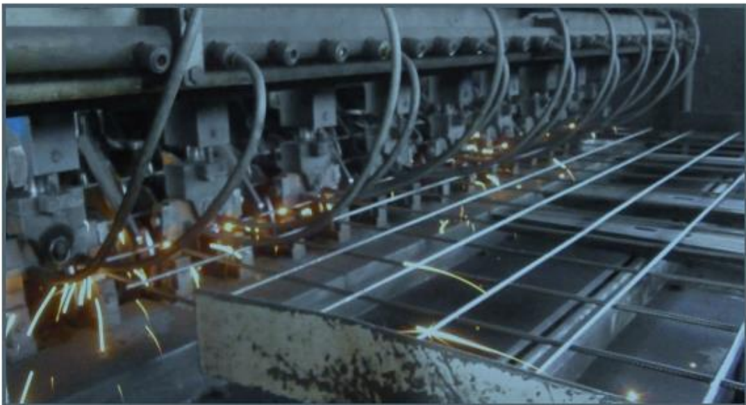
Slika 34. Proizvodnja armaturne mreže
