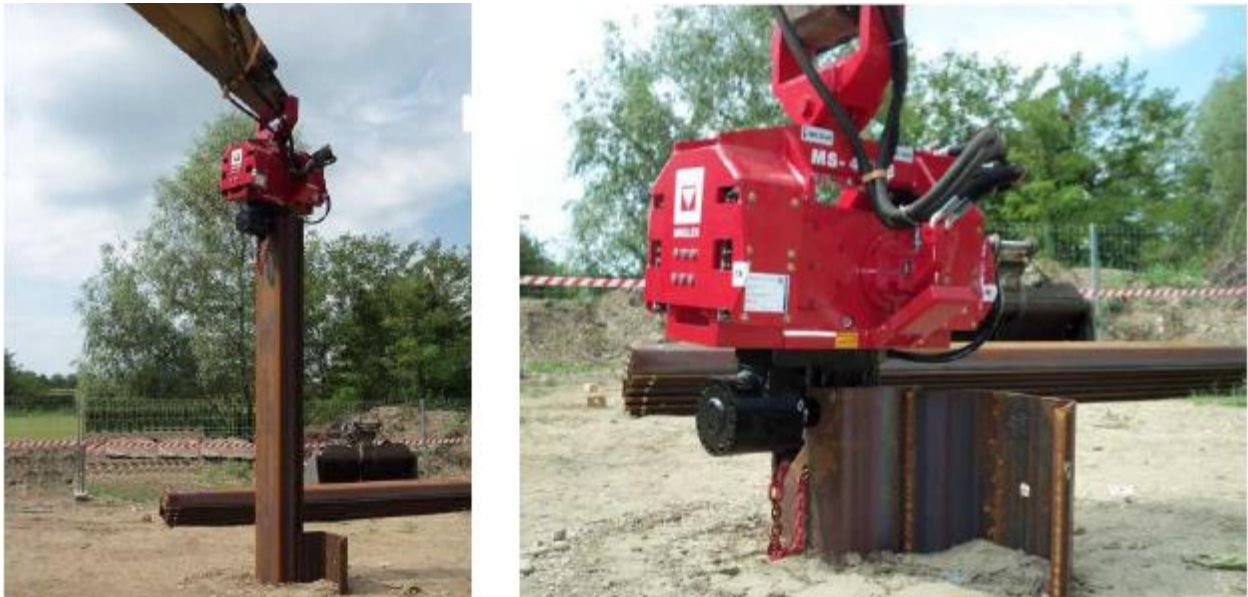
Slika 7. Vibrator za nabijanje i vađenje talpi
