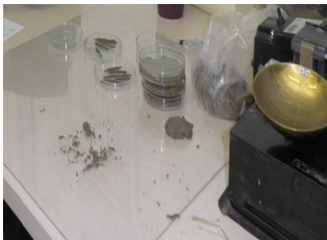
Slika 9. Radni stol - granice plastičnosti
