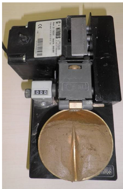
Slika 8. Casagrandeov uređaj sa ispitnim uzorkom
