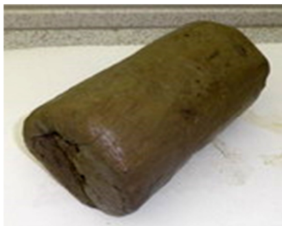
Slika 1. Neporemećeni ispitni uzorak
