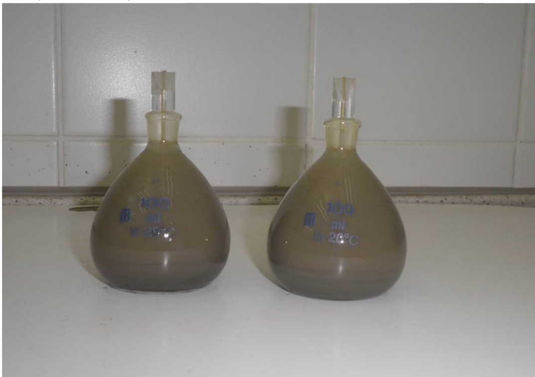
Slika 4. Ohlašeni piknometri s materijalom na 20°C
