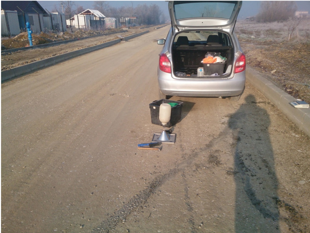
Slika 19. Terensko ispitivanje stupnja zbijenosti
