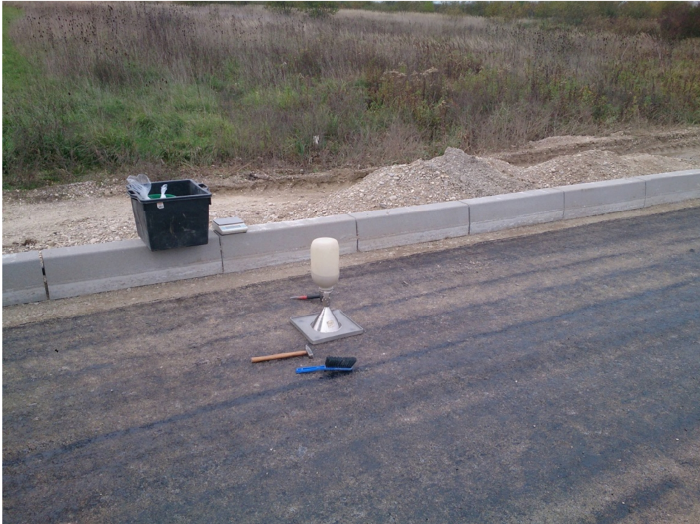
Slika 20. Terensko ispitivanje stupnja zbijenosti
