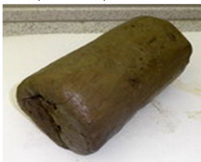
Slika 1. Neporemećeni ispitni uzorak
