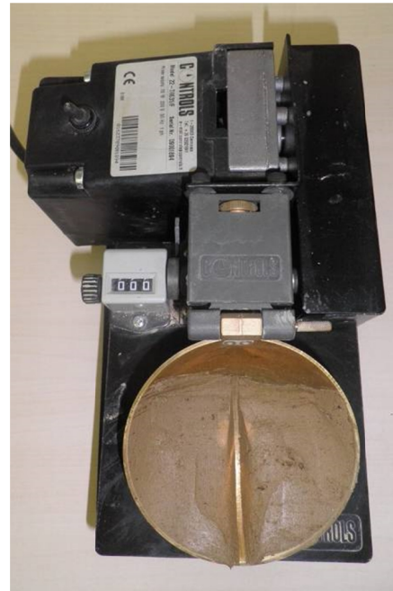
Slika 8. Casagrandeov uređaj sa ispitnim uzorkom
