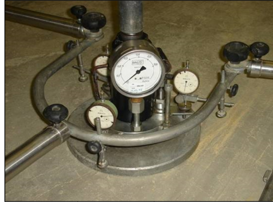
Slika 16. Mjerne urice u položaju ispitivanja
