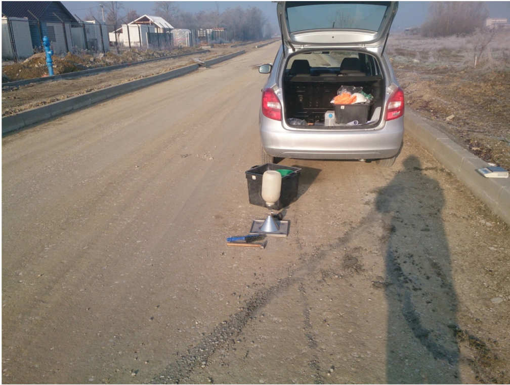
Slika 19. Terensko ispitivanje stupnja zbijenosti
