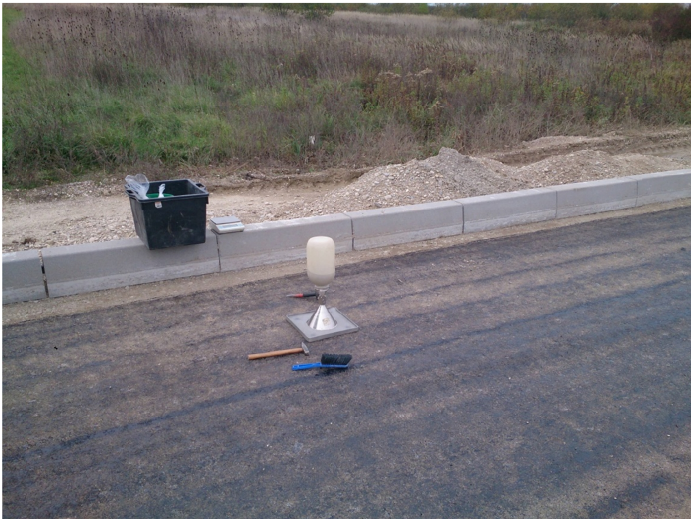
Slika 20. Terensko ispitivanje stupnja zbijenosti
