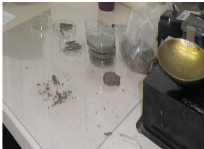
Slika 9. Radni stol - granice plastičnosti
