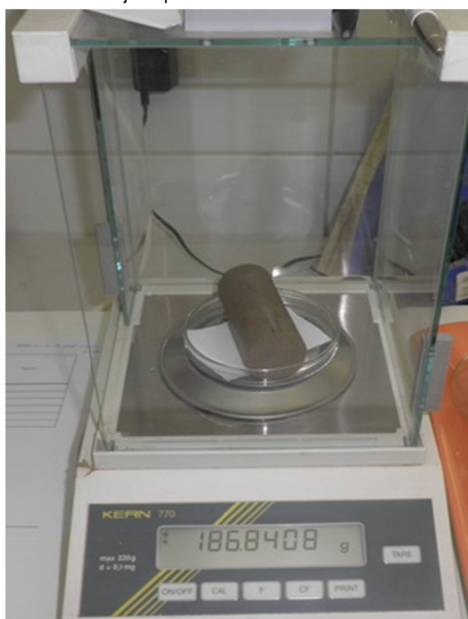
Slika 5. Ispitni uzorak izvađen iz kalupa za određivanje zapreminske težine
