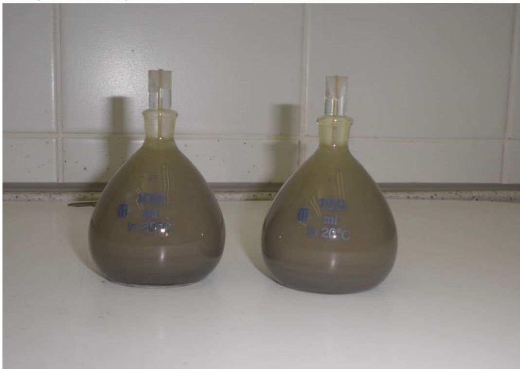
Slika 4. Ohlašeni piknometri s materijalom na 20°C
