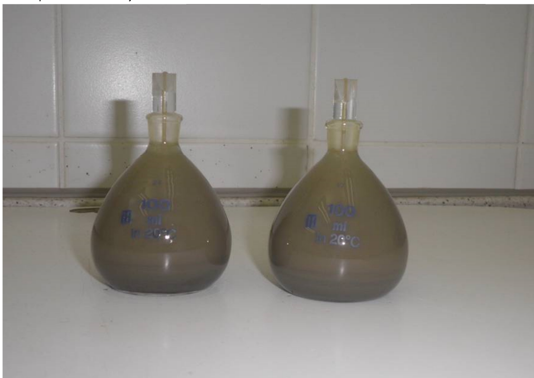
Slika 4. Ohlašeni piknometri s materijalom na 20°C
