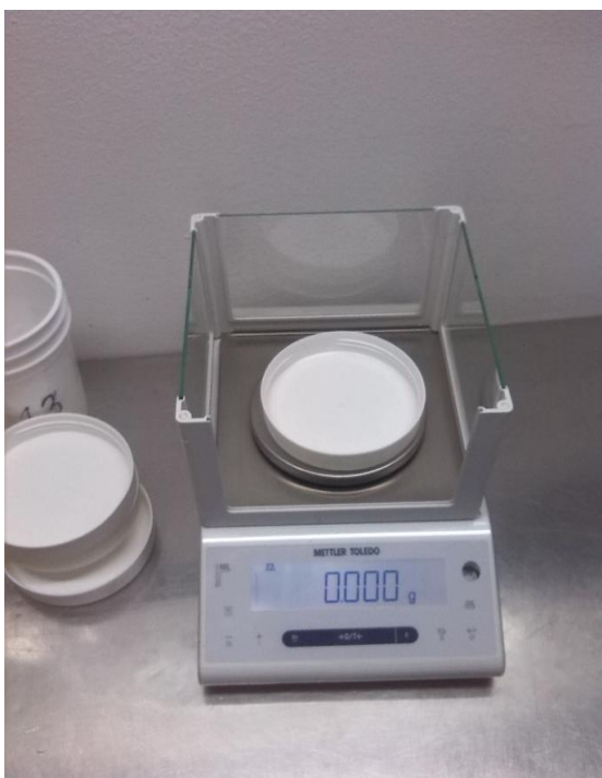
Slika 15: Digitalna vaga za mjerenje masa kapsula
