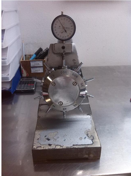
Slika 12: Pribor za mjerenje debljine tjemena kapsula
