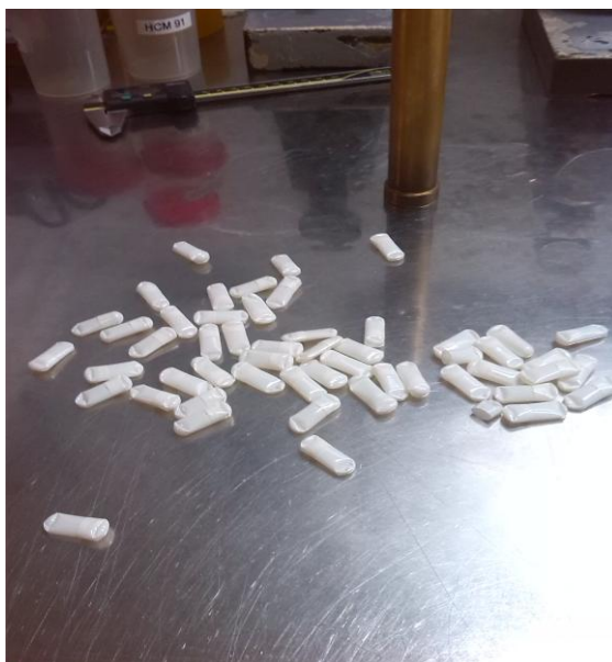
Slika 7: Testiranje krhkosti kapsula
