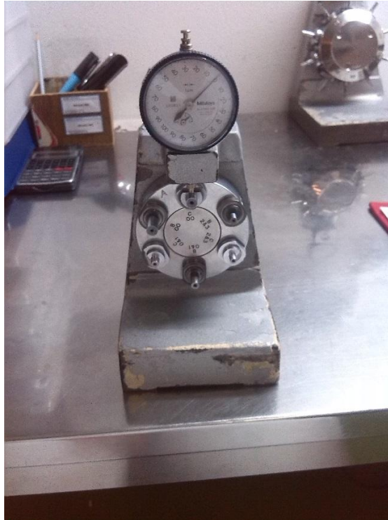
Slika 11: Pribor za mjerenje debljina stijenki kapsula
