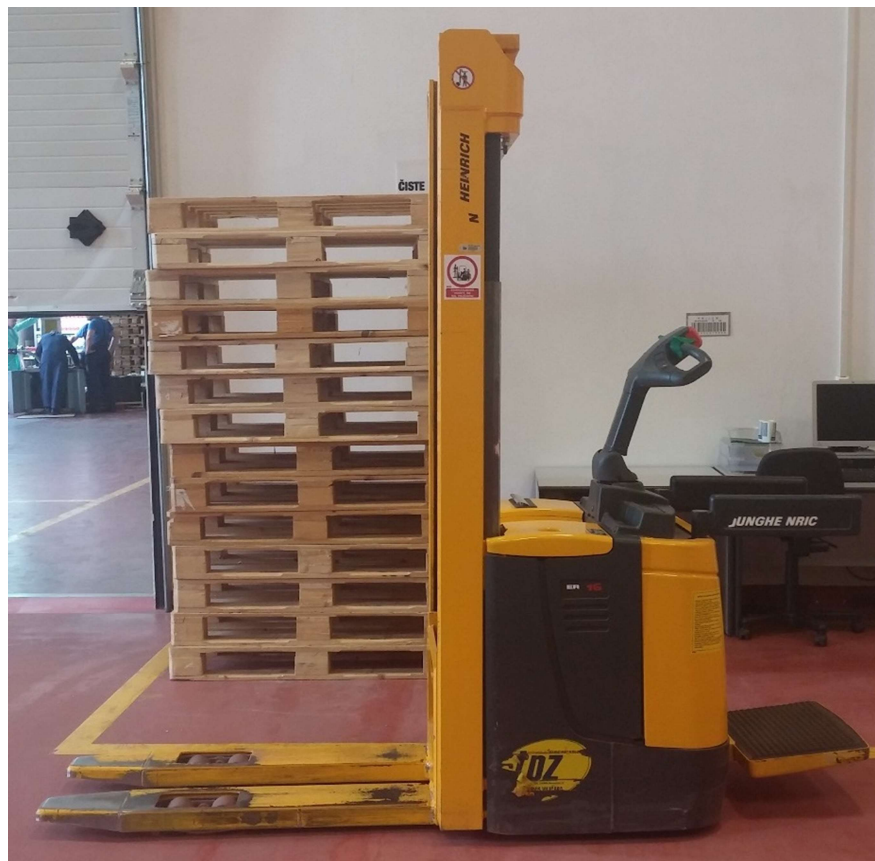
Slika 4.11 Visoko podizni viličar Jungheinrich ERC-Z 16
