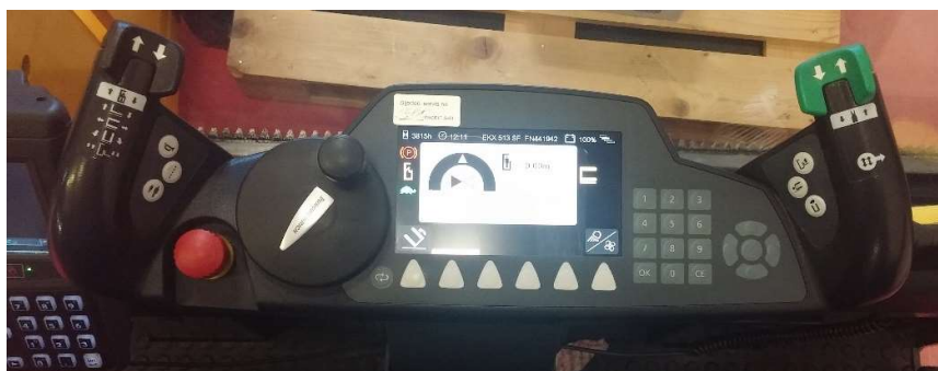
Slika 4.13 Upravljačka ploča Jungheinrich EKX 410
