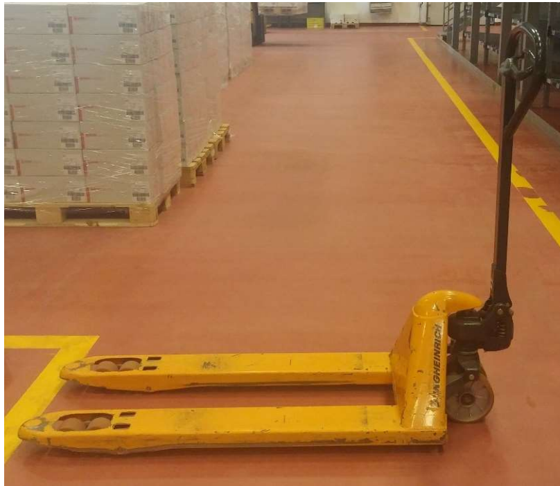
Slika 4.9 Ručni viličar Jungheinrich AM 2200
