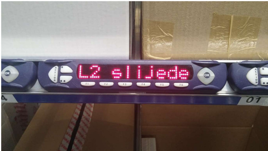
Slika 4.26 BayDisplay u PTL sustavu
