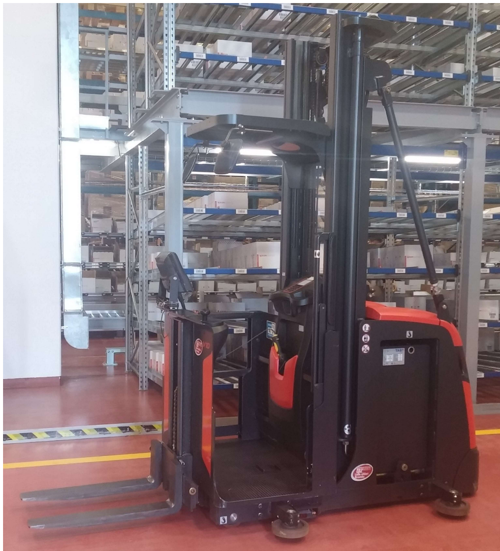
Slika 4.16 Komisioni viličar Linde V10
