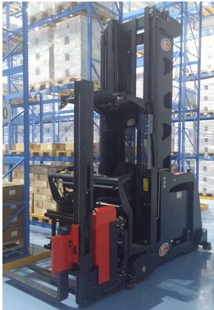
Slika 4.15 Visokoregalni viličar LINDE K
