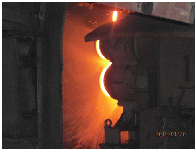
Slika 2.3: Razvlaknjavanje taline na centrifugi [8]
