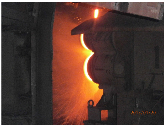
Slika 2.3: Razvlaknjavanje taline na centrifugi [8]
