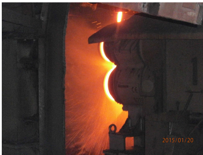
Slika 2.3: Razvlaknjavanje taline na centrifugi [8]
