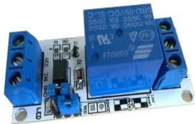
Slika 11. Relejni modul 5V 10 A s optoizolatorima
