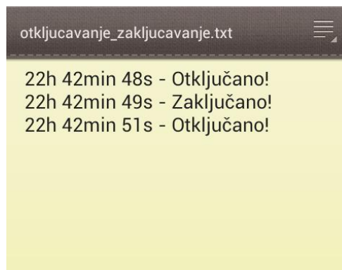
Slika 56. Izgled spremljenih podataka o stanju brave
