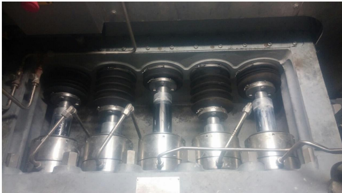
Slika 5.1 Položaj klipova homogenizatora
