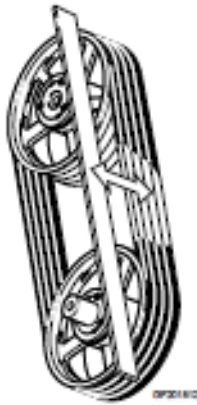
Slika 3.4 kontrola položaja remenica [1]
