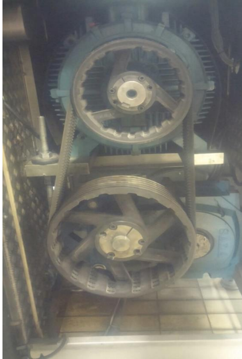
Slika 3.2 Pogonska jedinica homogenizatora
