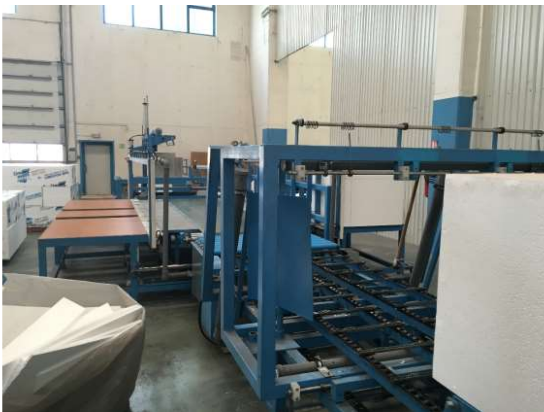
Slika 4.15 Stroj za rezanje stiropora
