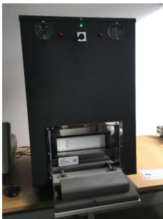
Slika 4.22 Uređaj za ispitivanje otpora prolaza topline
