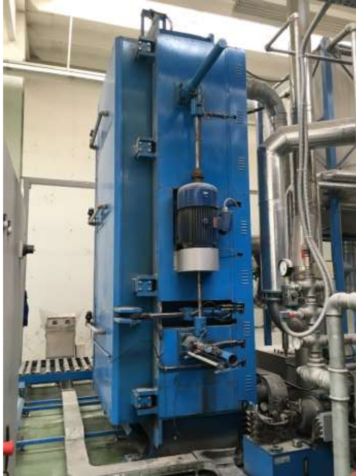
Slika 4.11 kalup za izradu EPS blokova
