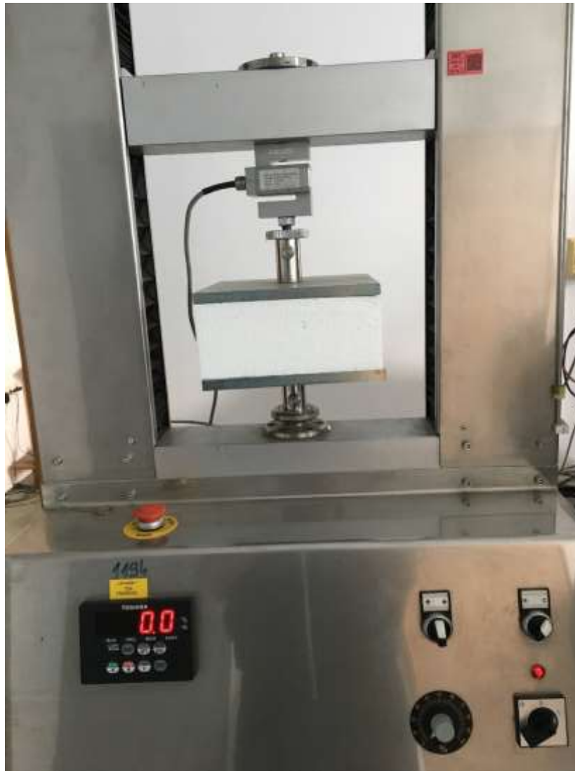
Slika 4.24 Ispitivanje debljine i debljine kod opterećena 250 Pa
