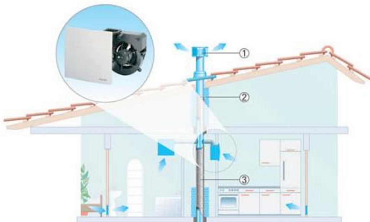
Slika 2.22 Princip prisilne lokalne ventilacije
