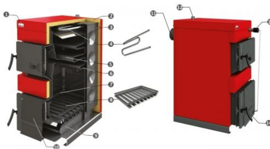
Slika 2.1 Primjer kotla na kruta goriva
