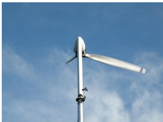
Slika 5. Vjetroturbina s jednom lopaticom [15]
