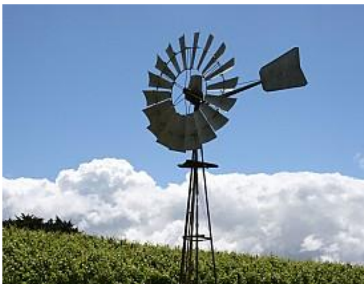
Slika 3: Američki tip vjetroturbine [13]
