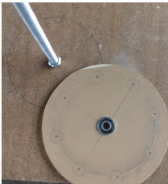
Slika 29: Postolje s označenim položajem namotaja i disk s označenim položajem magneta
