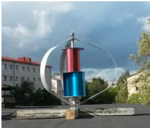
Slika 18. Darrieus - Savoniusova vjetroturbina [26]
