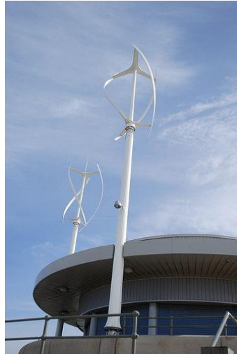
Slika 11. Vertikalna Darrieusova vjetroturbina sa spiralnim lopaticama [20]
