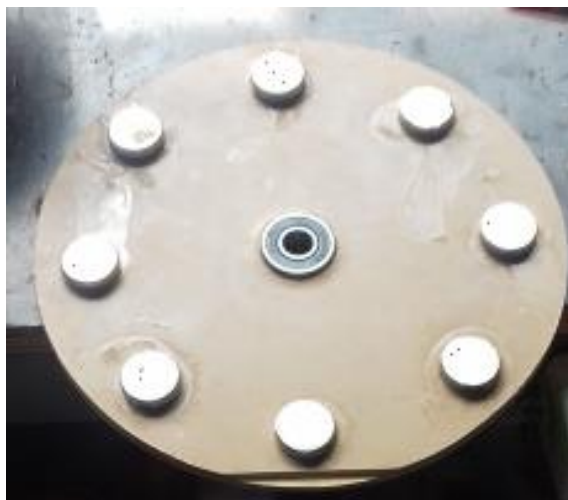
Slika 25: Disk sa pričvršćenim magnetima
