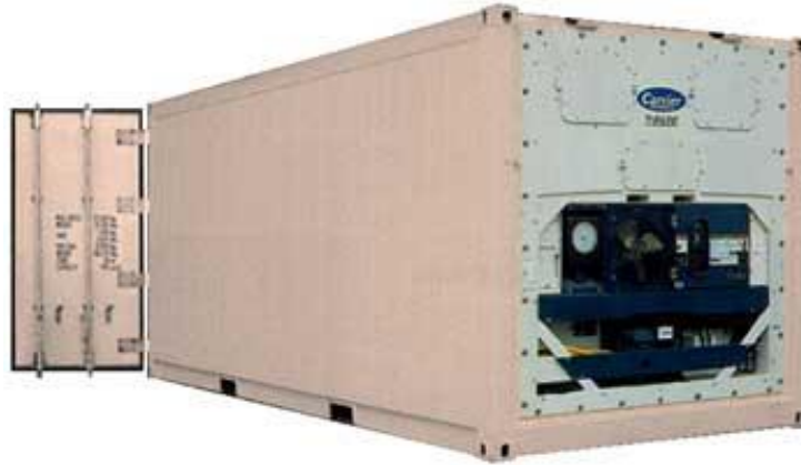
Slika 2.4.: Izotermički ili frigo kontejner [2]
