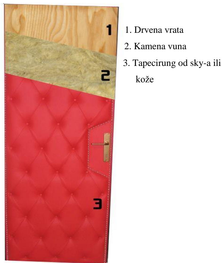
Slika 6.3.1. Prikaz slojeva zvučno izoliranih vrata
