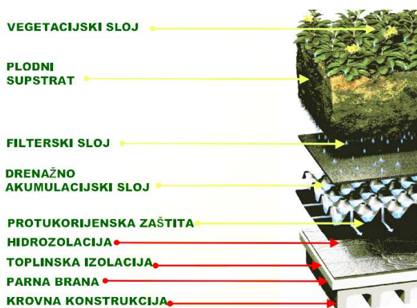
Slika 3.1. Osnovne komponente zelenog krova
