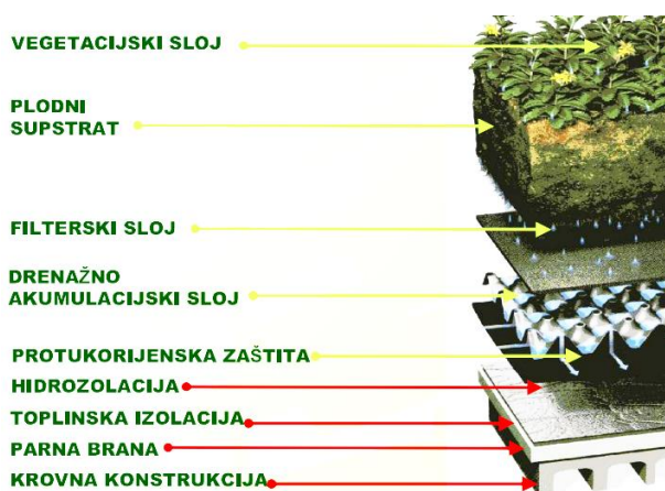
Slika 3.1. Osnovne komponente zelenog krova
