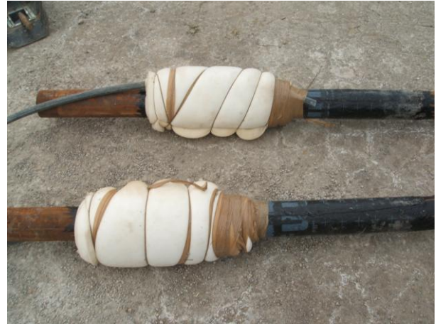
Slika 5.23. Brtva sa spojem čelične i okite cijevi
