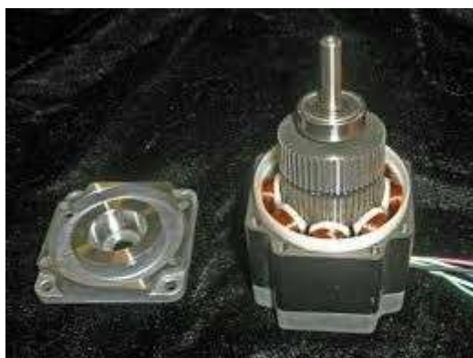
Slika 3. Reluktantni koračni motor [1]
