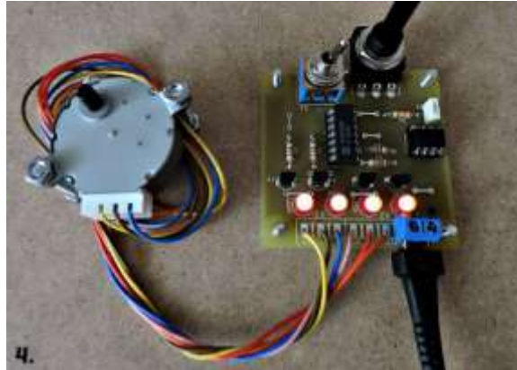
Slika 18. Sklop za upravljanje brzinom vrtnje unipolarnog koračnog motora; motor se okreće brzo
