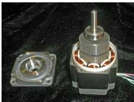
Slika 3. Reluktantni koračni motor [1]
